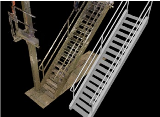
Vergleich zwischen einer gescannten Punktwolke links und einem daraus erstellten 3D-Modell rechts
