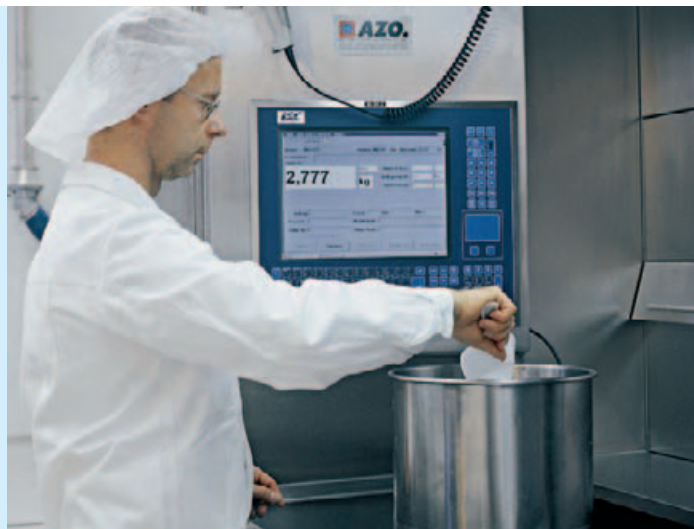
Bedienergeführtes Wiegen von Kleinstmengen mit ManDos
