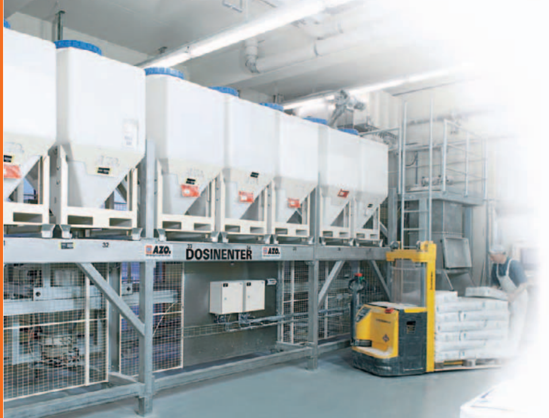
Vollautomatisches Wiegen mit dem DOSINENTER® für Kleinkomponenten, auf die häufig zugegriffen wird
