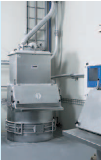
Einfülltrichter zur Aufgabe von Säcken in das geschlossene System
