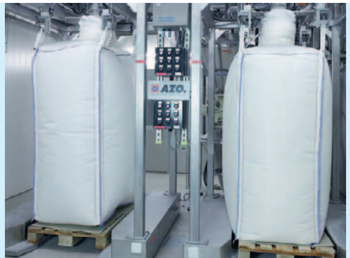
Automatisches Befüllen von Big-Bags mit exakter Gewichtskontrolle
