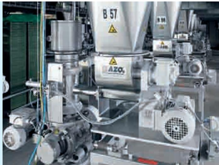
AZODOS®-Geräte zum exakten Wiegen der Kleinstmengen
