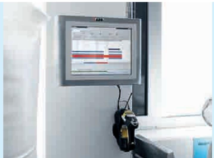
Bedienterminal mit Barcode-Scanner im Bereich der Rohstoffbereitstellung
