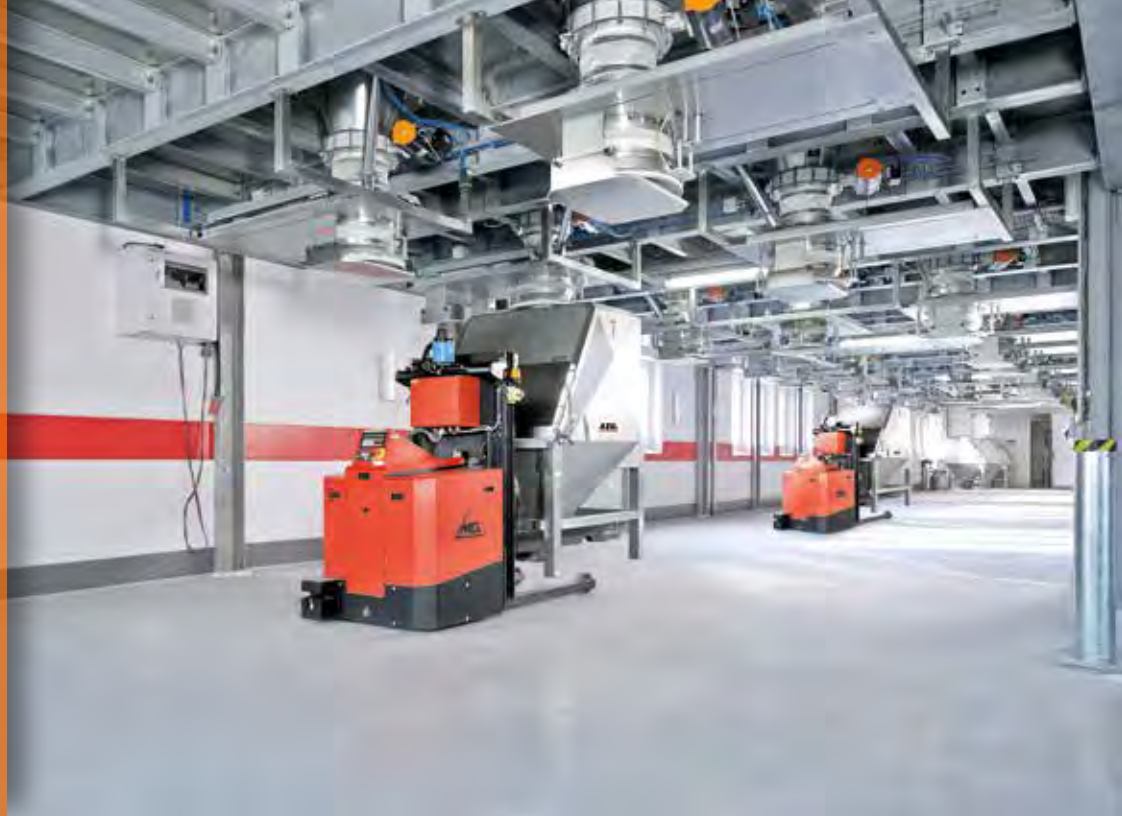
Einsammeln der Rohstoffe mit FTS Fahrzeugen in spezielle Container
