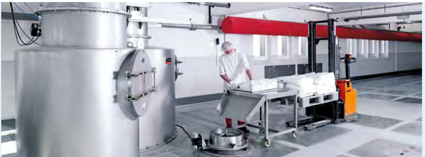
Befüllen der Innensilos mit Kräutern aus Säcken über einen Vibrationssieb
