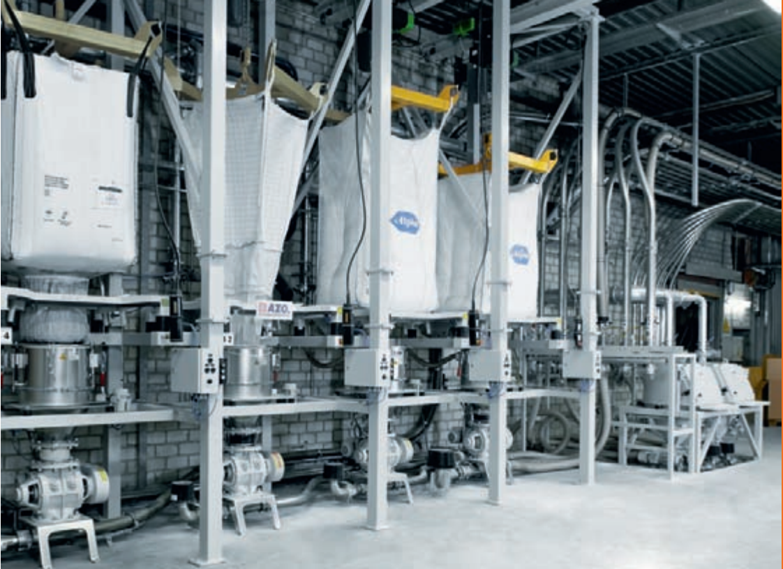
Big-Bag Entleerstationen zur staubfreien Produktaufgabe ins geschlossene System
