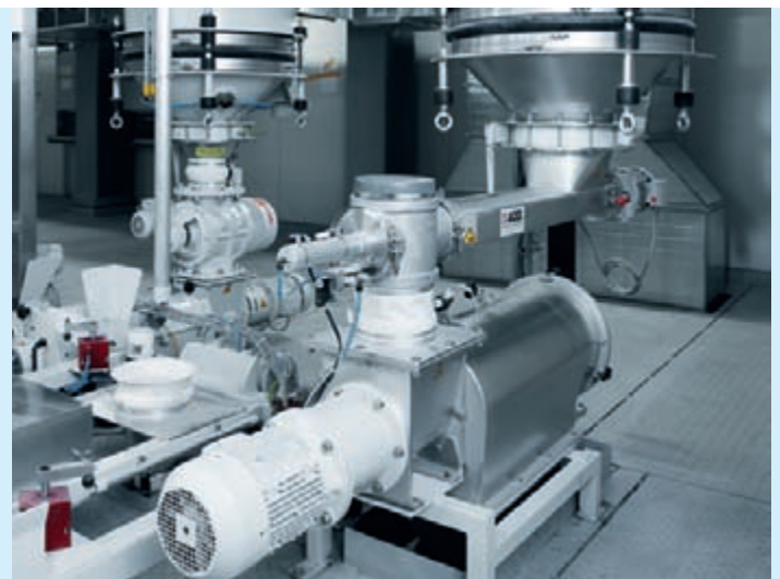
Effizientes Sieben der Rohstoffe mit AZO Wirbelstrom-Siebmaschinen
