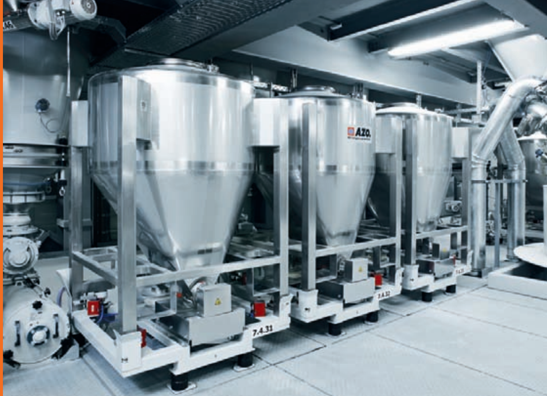
AZO DOSITAINER® mit integrierter Dosierschnecke als flexible Produktzugaben im AZO COMPONENTER®
