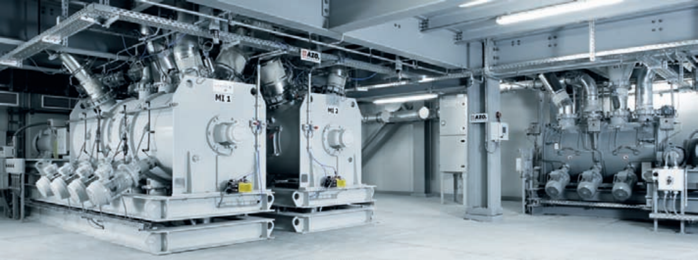
Zwei Horizontalwellen-Mischer zur Herstellung der Standardprodukte, rechts ein Mischer für Vormischungen und Spezialprodukte
