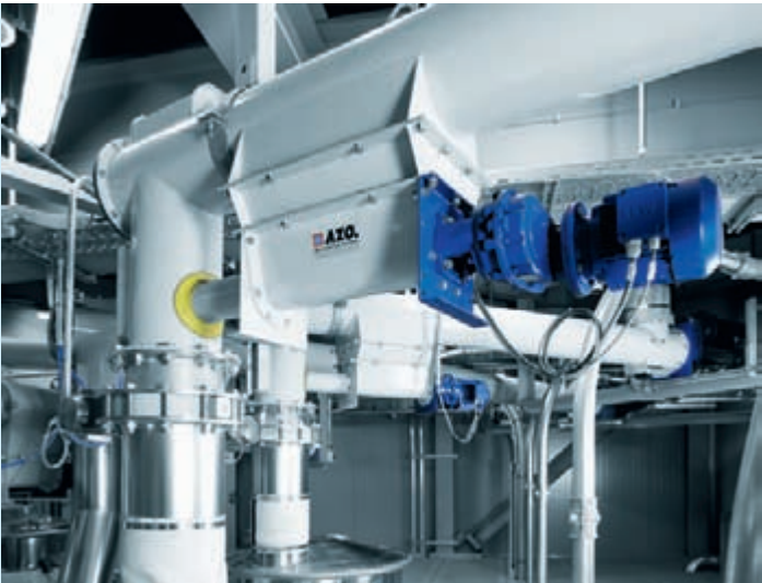
Dosierschnecke mit nachgeschalteter Feinstdosierung
