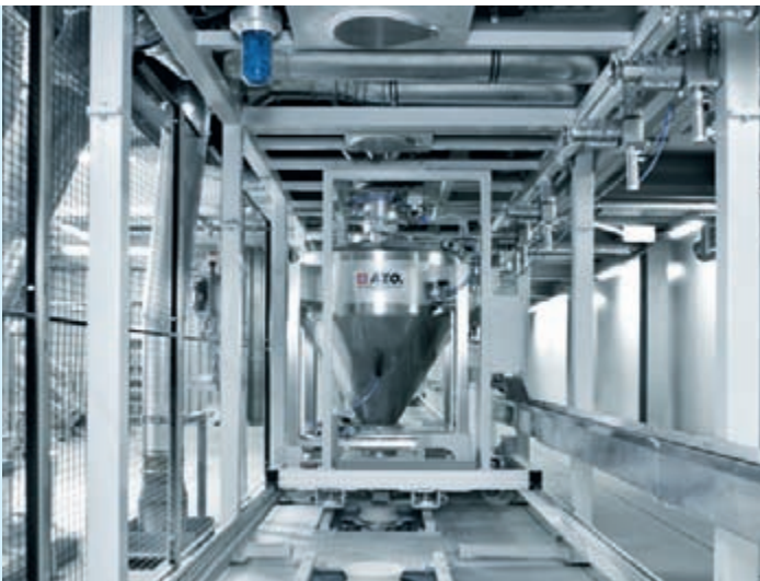
Der Behälter der fahrbaren Waage kann bei Produktwechsel ausgetauscht werden
