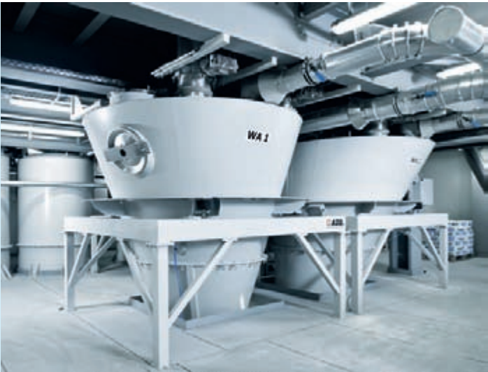
Behälterwaagen zum genauen Wiegen der Großmengen
