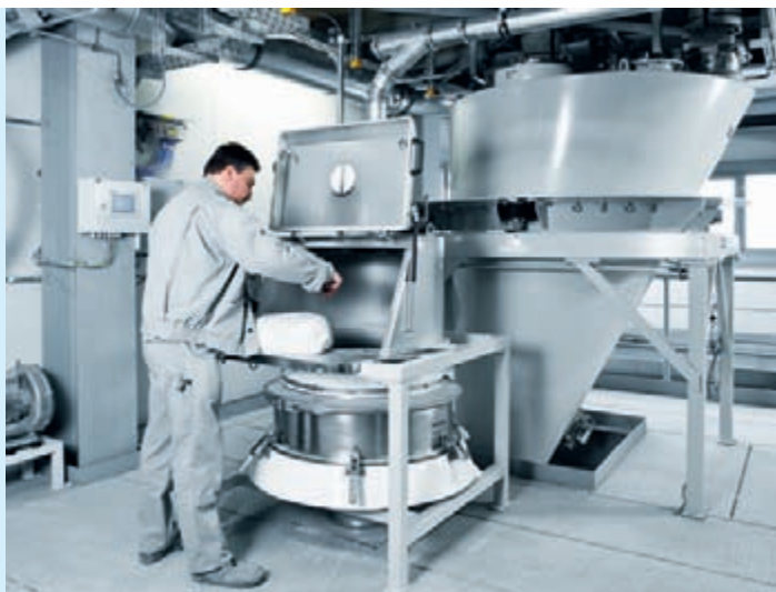
Behälterwaage für Vormischungen, vorgewogene Rohstoffe werden direkt über einen Einfülltrichter in den Mischer gegeben
