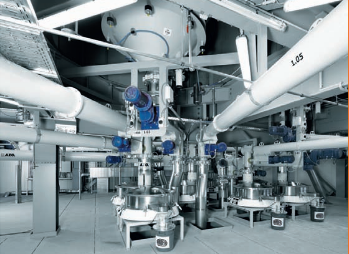
Sichere Produktaustragung über Vibrationsböden und Dosierschnecken mit anschließender Kontrollsiebung
