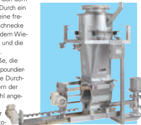
Rührwerk und Dosierschnecke ganz ausgezogen
