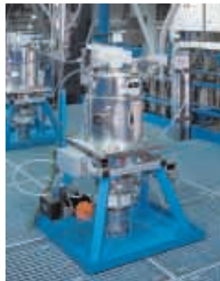
MIXOVERT®-Mischer zum Beschicken von Dosiersystemen
