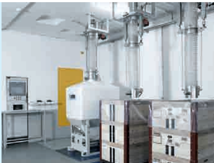
Bedienterminal mit Barcode-Scanner im Bereich der Fertigwarenabfüllung
