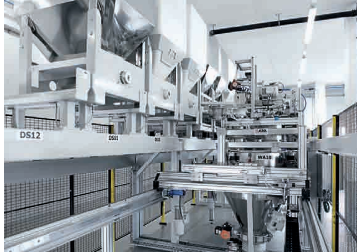
Fahrbare Waage des DOSINENTER® mit Andocksystemen für DosiBoxen® und DOSITAINER®
