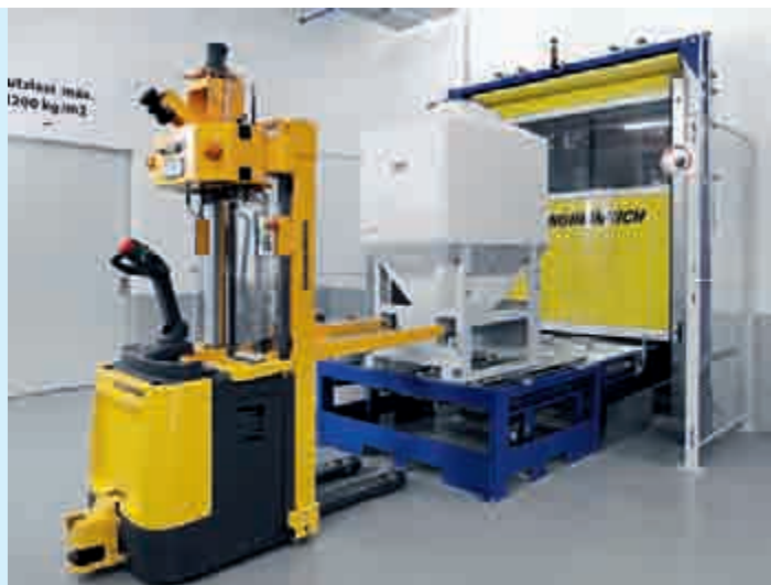
Fahrerloser Hubstapler zum vollautomatischen Handling der Rohstoffbehälter
