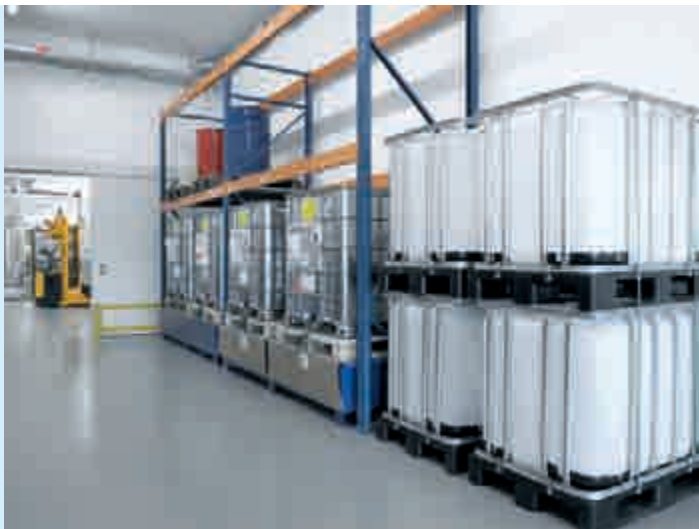
Flüssigkeitenlager mit Containern aus Kunststoff und Metall
