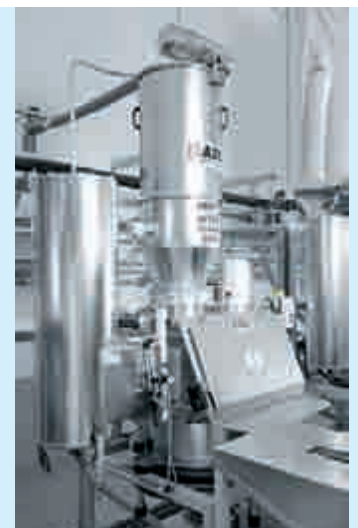
Einfülltrichter mit Leersackverdichter und zusätzlichem Abscheider für pneumatische Befüllung
