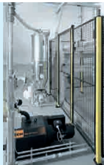
Saugförderung zur Beschickung des Verdichterwalzwerkes
