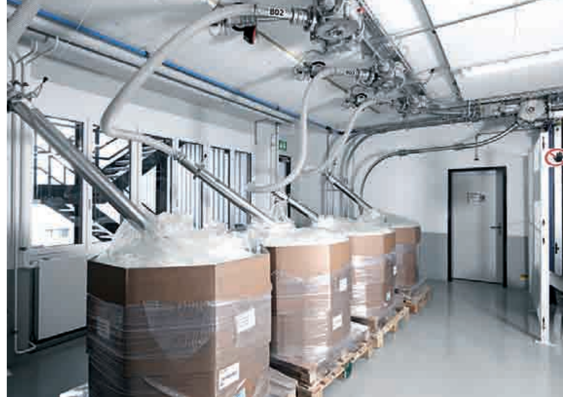
Saubere Aufgabe der Mittelkomponenten aus Oktabins über Saugfördersysteme
