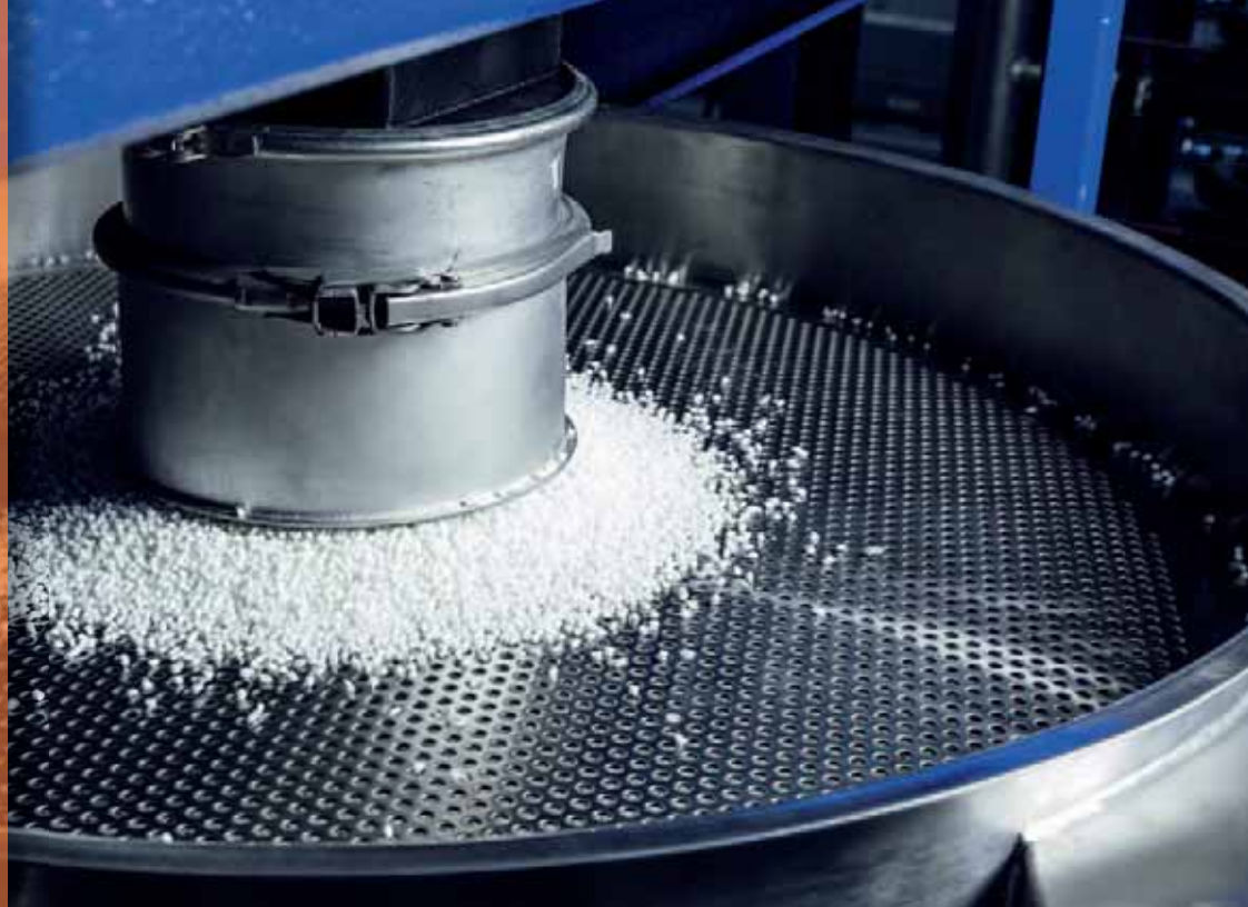
Vibrationsflachsieb zum Aussieben von Über- und Unterkorn
