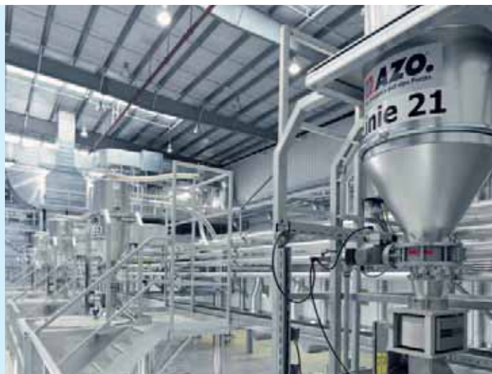
Beschickung der Tagessilos über Abscheider mit nachgeschaltetem Metallausseider
