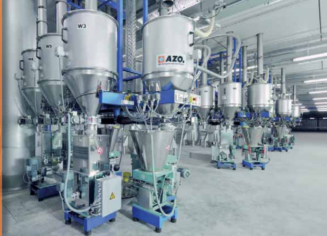
Extruderbeschickung über Differential-Dosiergeräte
