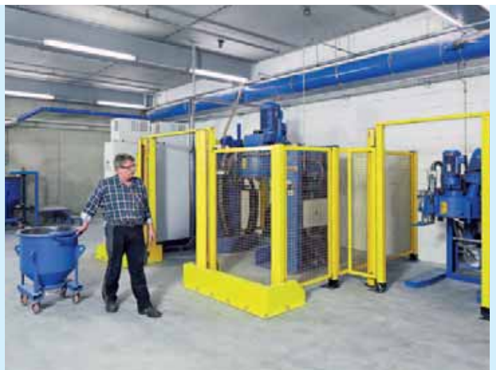
Mit Hilfe des Containermischers wird direkt im Container eine homogene Mischung erzeugt
