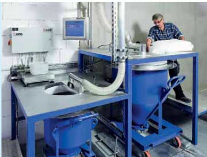
Manuelle Wiegestation ManDos zum Aufgeben vorgewogener Säcke in Mischcontainer
