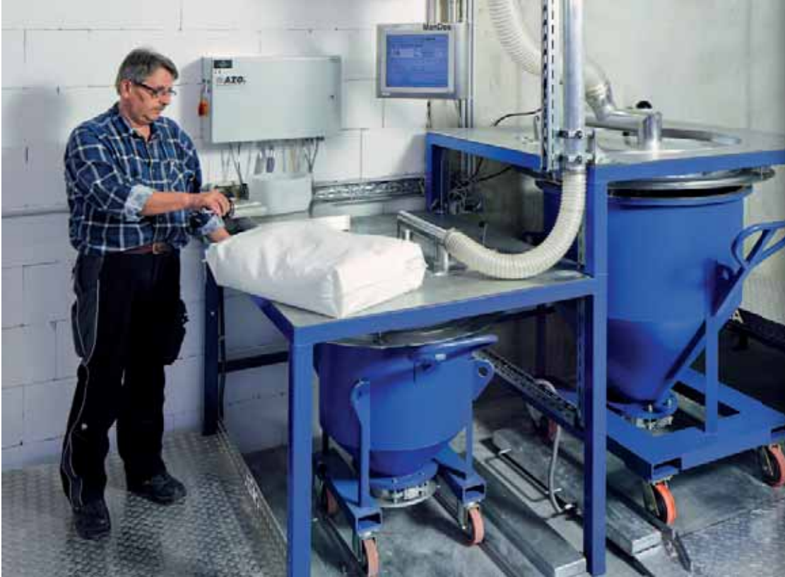
Manuelle Wiegestation ManDos zum grammgenauen Wiegen und Aufgeben von Kleinstmengen
