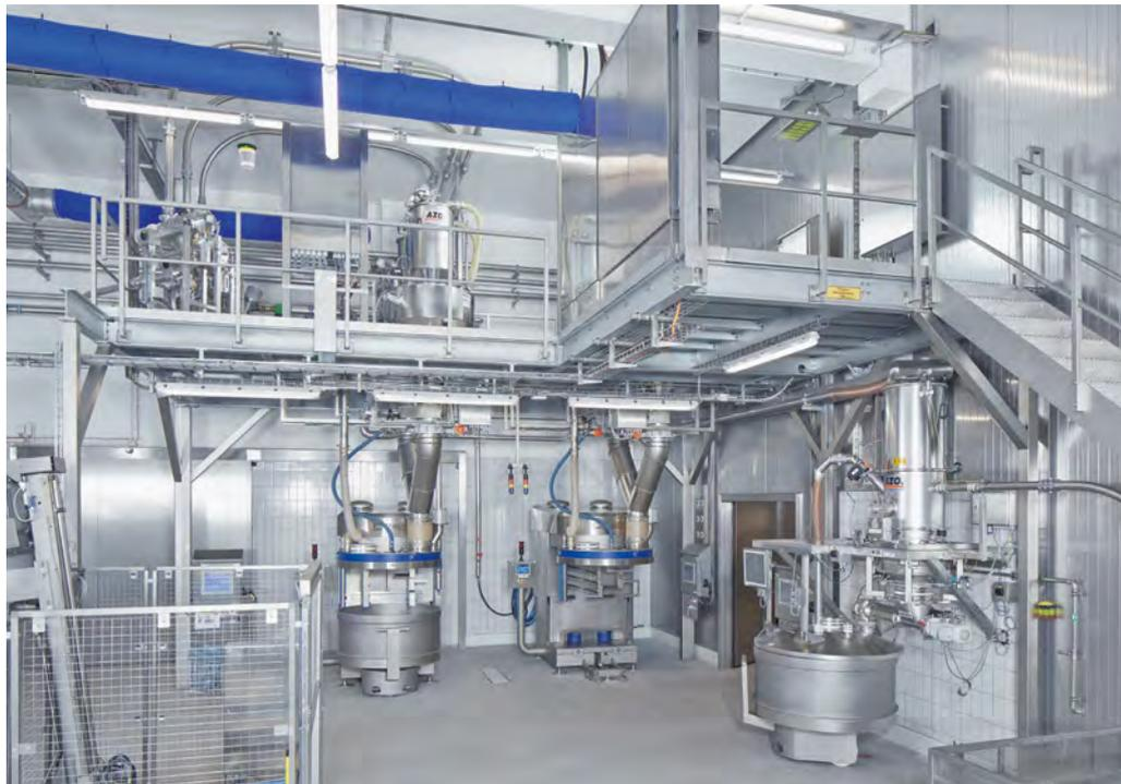
揉面生产线的安全供料，采用真空称量系统，几乎不产生粉尘
