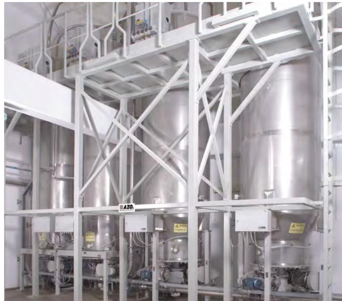
Tagessilos, die von den großen Silos per Druckförderung beschickt werden
