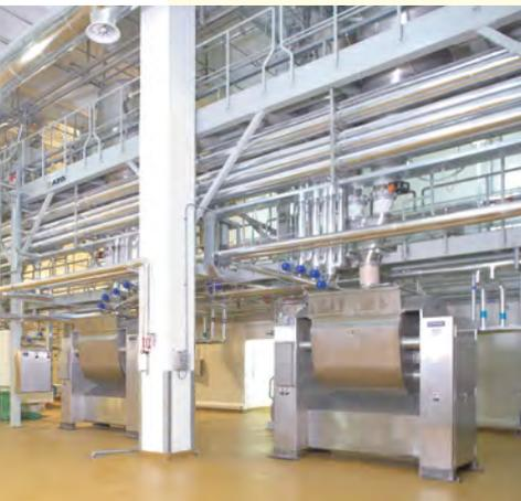
**Die innovative Lösung von AZO** zeichnet sich dadurch aus, dass alle Rohstoffe, sowohl Schüttgüter als auch Flüssigkeiten zuverlässig und unabhängig von Gebindeformen in den automatischen Zuführprozess integriert werden. Die prozessoptimierte Kneterschickung ermöglicht ein optimales Knetergebnis und sorgt so für konstant hohe Produktqualität.
