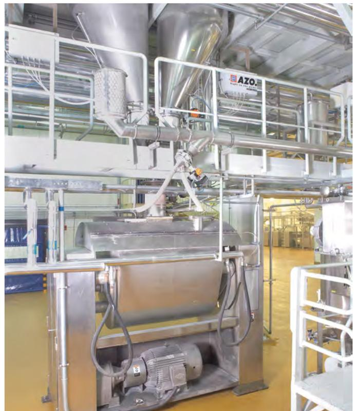
Beschickung eines Kneters über Mehl- und Zuckerwaage
