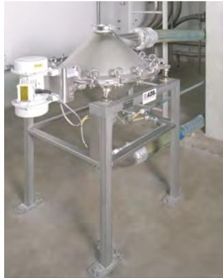
Siebmaschine Typ TW zum Kontrollsieben der angelieferten Mehle
