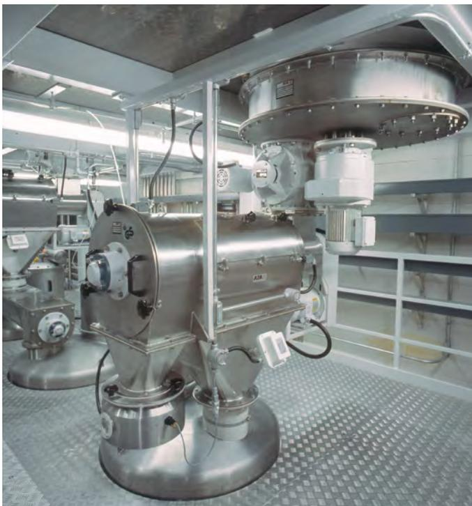
Wirbelstrom-Siebmaschine zum Kontrollsieben
