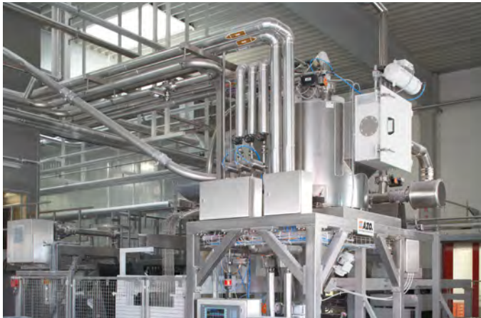
Saugwiegesysteme mit Förderwaagen zur Beschickung verschiedener Prozesslinien
