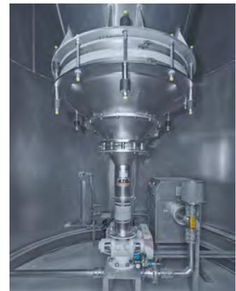
Einschleusung des Zuckers in das Saugwiegesystem mit aufbereiteter Luft
