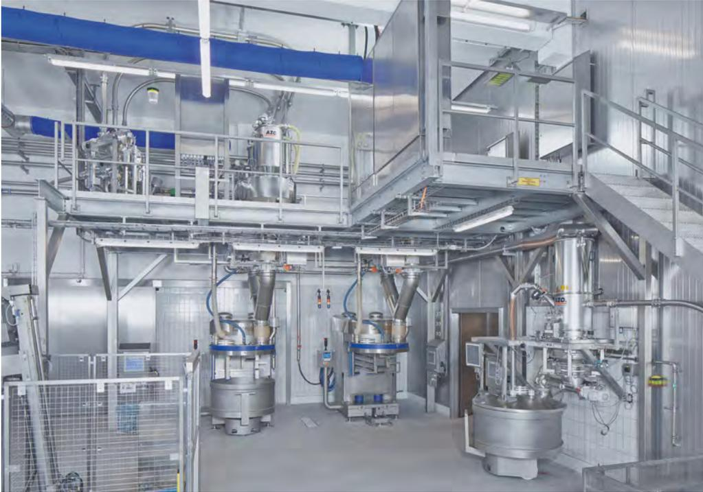
Sichere und staubarme Beschickung der Knetelinien durch Saugwiegesysteme
