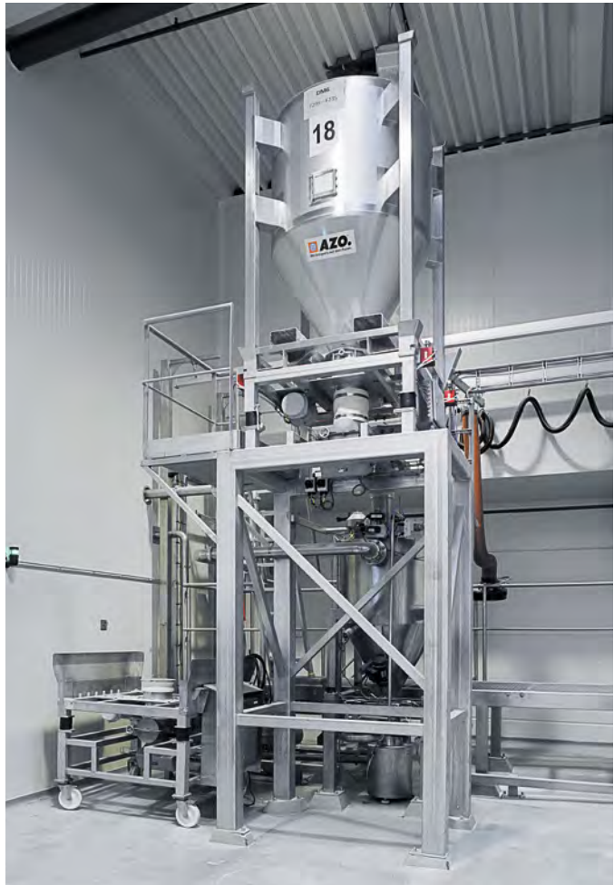
Containeraufgabestation zur Beschickung eines Inline-Mischers, links: fahrbare Station zur Beschickung der Rührbehälter
