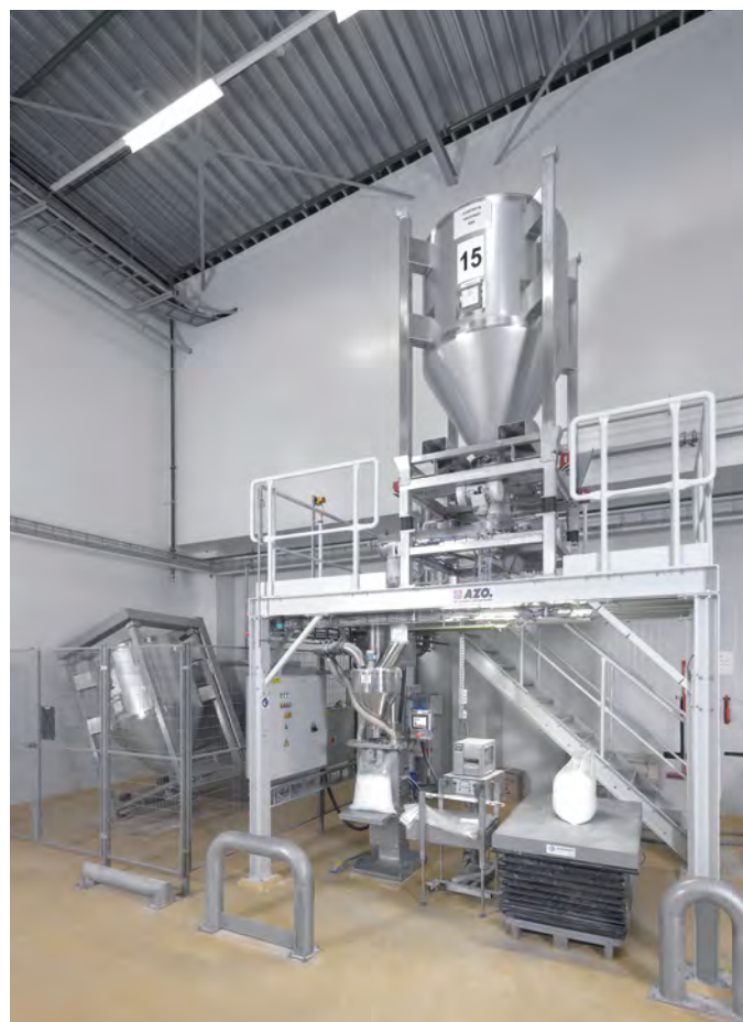
Halbautomatische Absackanlage zum Abfüllen der Trockenmischungen in Beutel und Säcke
