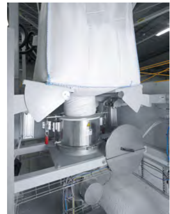
Big-Bag Entleerstation mit Walkeinrichtung
