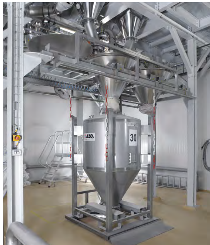
Einwaage von hellen und dunklen Produkten in BATCHTAINER® über verschiebbare Trichter
