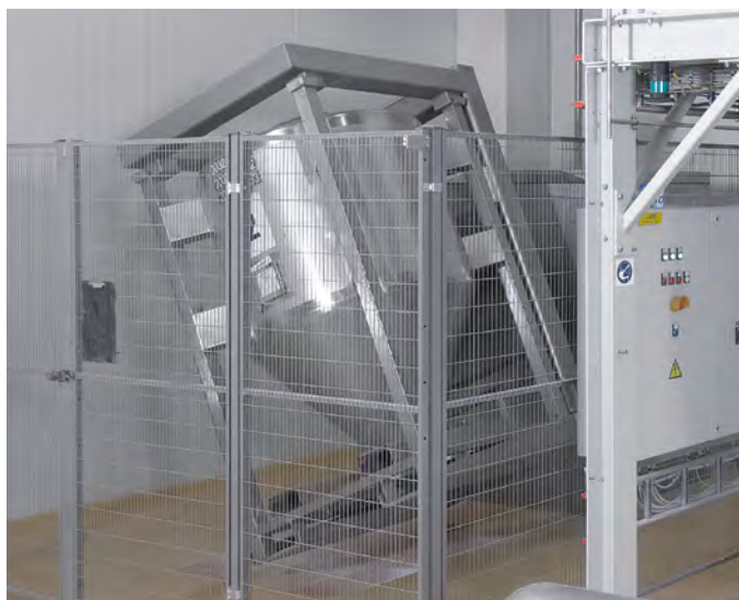
Containermischer zur Herstellung homogener Trockenstoffmischungen
