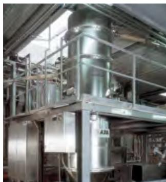
Saug-Druck-Wiegesystem mit CO<sub>2</sub>-Beaufschlagung
