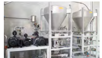
Container-Aufgabestation und Unterdruckerzeuger
