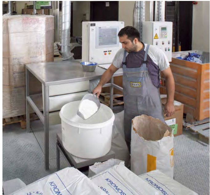
ManDos, bedienergeführtes manuelles Wiegen von Farben, Additiven und Zuschlagstoffen
