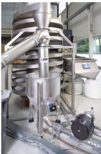
Granulatkühlung und Beschickung der Abfüll-Homogenisiersilos
