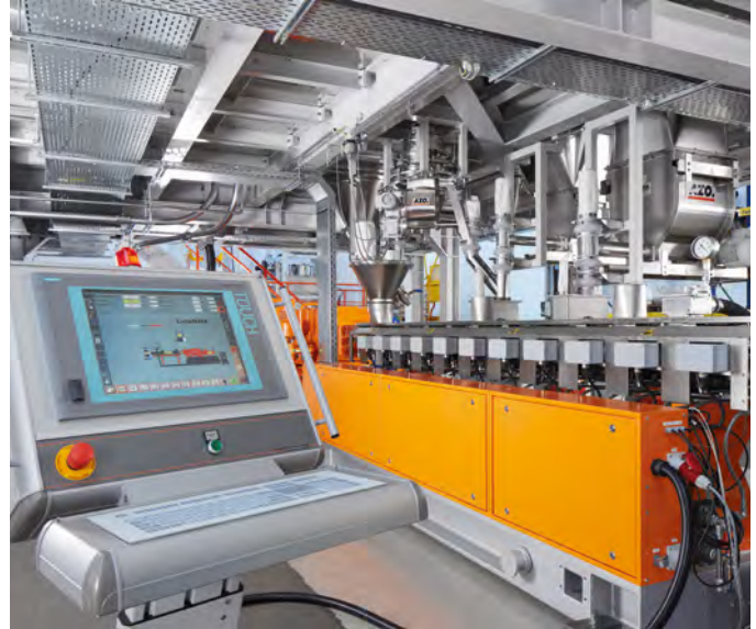
MacromateXX S7 professional von Leistritz zur Steuerung des Extrusionsprozesses und aller Nachfolgeaggregate
