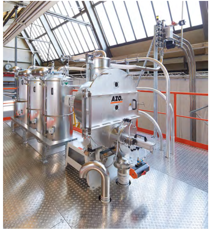
Abscheider zur Beschickung der AZODOS®-Geräte und AZO®MIXOMAT zur Herstellung von Vormischungen
