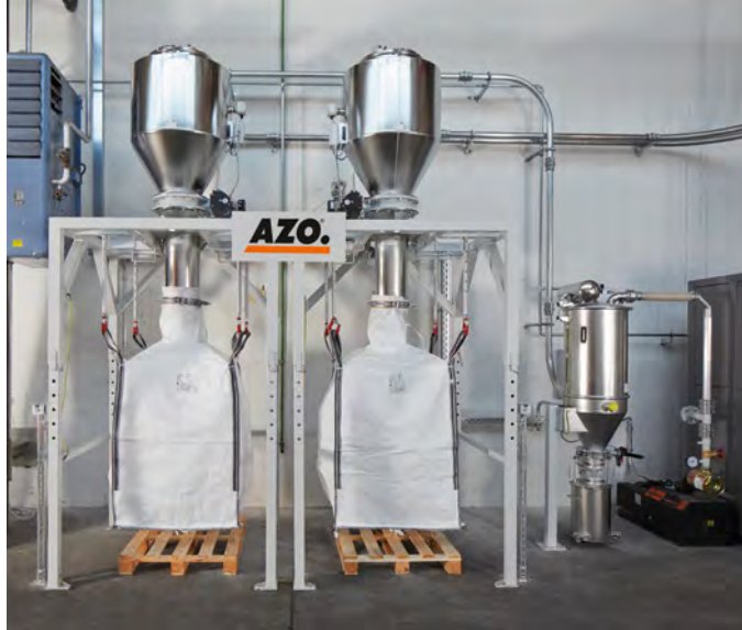
Abfüllen der Fertigware in Big-Bags mit Hilfe einer Saugfördieranlage
