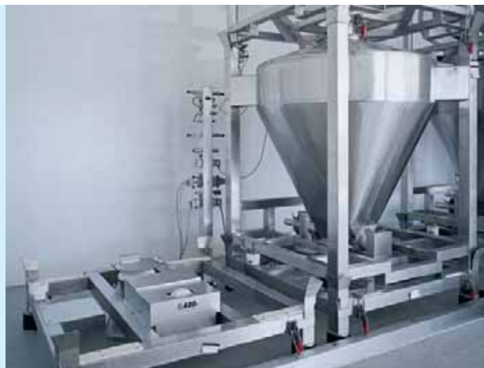
配备集成驱动装置的 AZO DOSITAINER® 卸料站
