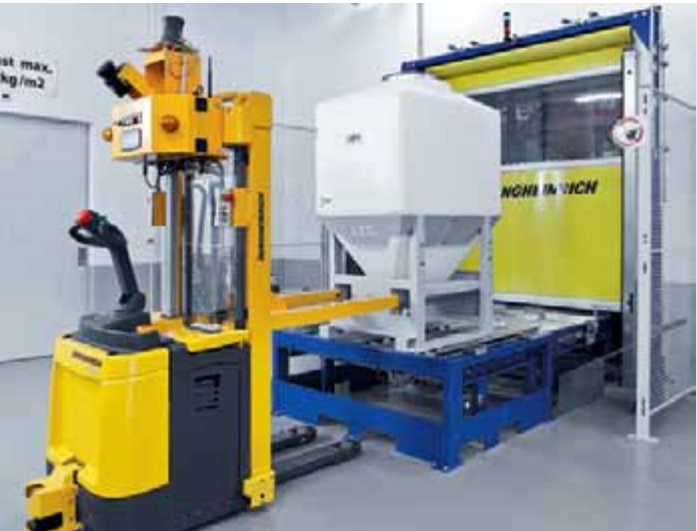
通过无人驾驶运输车对 DosiBoxes®进行 实现入库和出库处理
