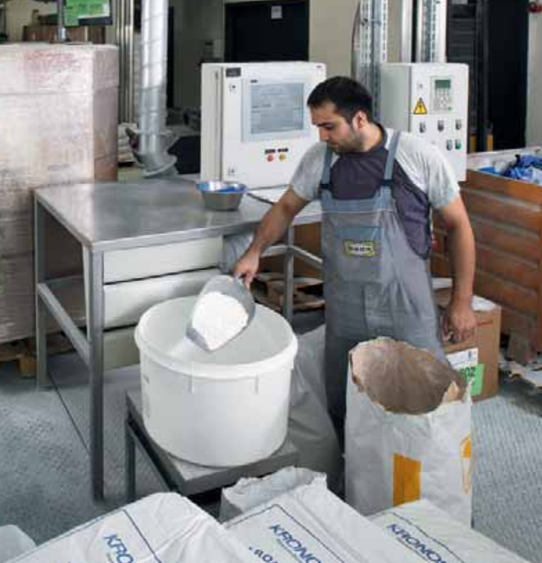
塑料混合加工中颜料和添加剂的人工称重台
