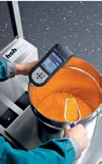
移动式 ManDos：通过移动式秤以及移动式终端电控设备与 WLAN 连接实现最高程度的灵活性
