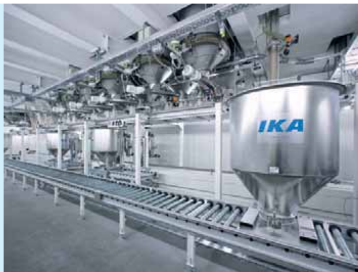
配备动态秤的 AZO MIXTAINER® 中添加剂的采集
