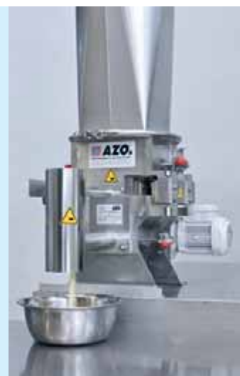
配备微型计量装置的 AZODOS®
