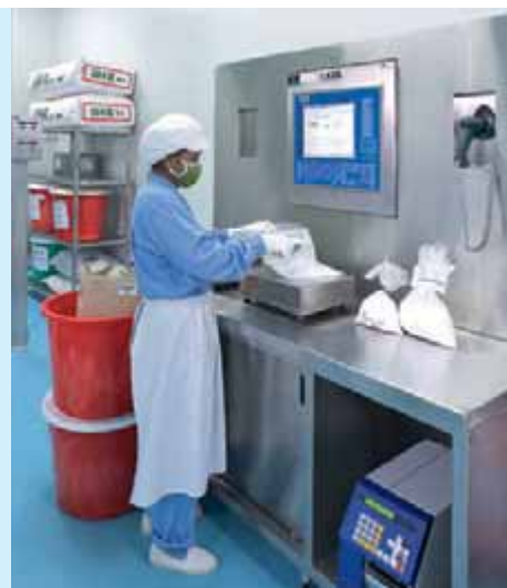
ManDos 称重台配备条形码记录器和称重标签打印机
