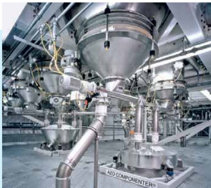
生产窗户型材使用的环形 AZO COMPONENTER®
