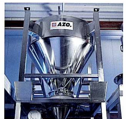
Container-Aufgabestation mit Vorsieb
