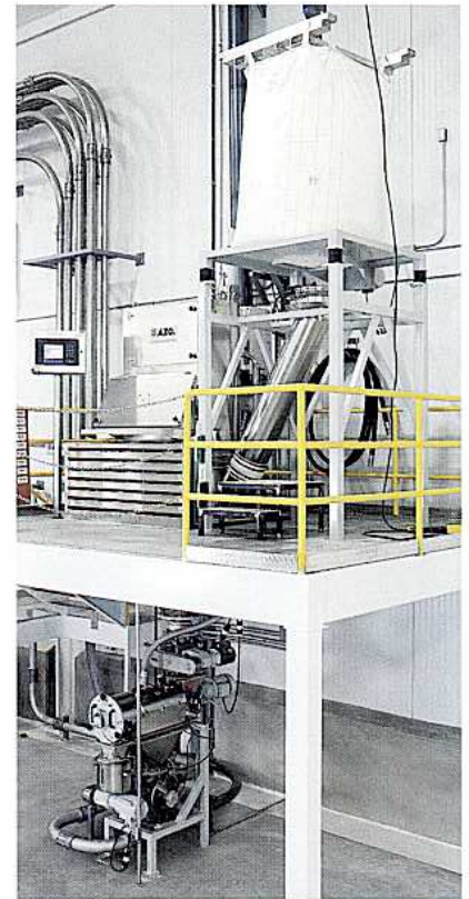
Eingangskontrolle mit Wirbelstrom-Siebmaschinen
