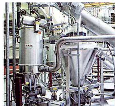
Hochdruckschleuse zur schonenden Granulat-Förderung
