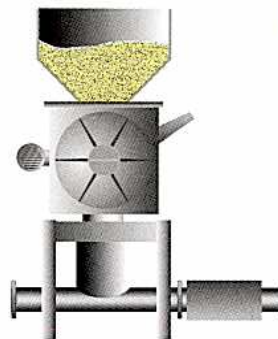
Hochdruckschleuse Zum Einspeisen von granulatformigen Schüttgütern bei langsamen Fördersystemen in höhe- und platzsparender, kompakter Bauweise.
