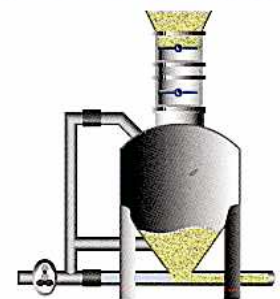
Druckgefäß Produktaufgabe im Chargenbetrieb bei hohen Drücken und weiten Förderwegen möglich. Mit Lavaldüse auch als schonende Langsamförderung einsetzbar.
