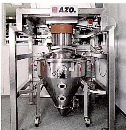
Fahrbarer Absaugtrichter mit Impulsventil
