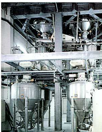
Druckimpuls-Fördersystem zum Beschicken einer Absackanlage und Big-Bag-Befüllung
