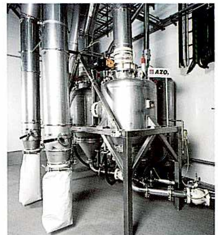
Druckgefäße zum Fördern wärmeempfindlicher Schüttgüter
