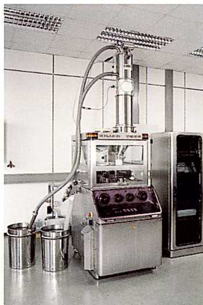
Schonende Beschickung von Tablettenpressen
