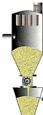
Abscheider mit Austragschleuse Dient zum kontinuierlichen Abscheiden, Austragen und gleichzeitigem Dosieren in nachfolgende Verarbeitungsprozesse.
