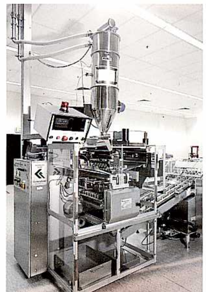
Entmischungsfreies Beschicken von Abfüllautomaten
