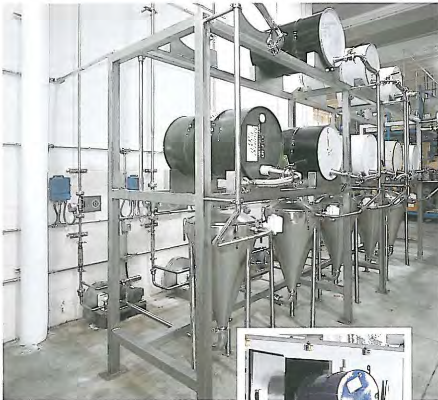
Aufgabe von flüssigen Klein- komponenten aus Fässern
