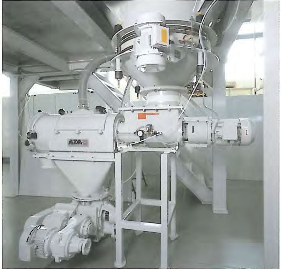
Wirbelstrom-Siebmaschine mit Eigendosierung
