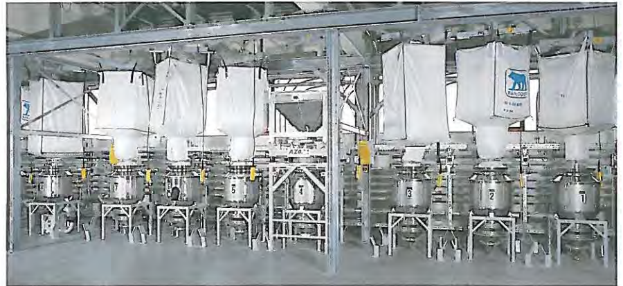
In den Produktionsablauf integrierte Big-Bag-Aufgabestationen
