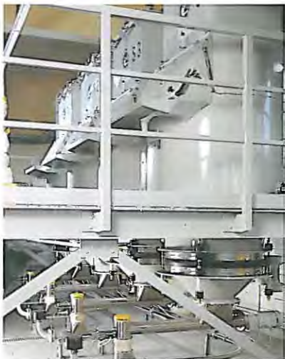
Einfülltrichter mit Vibrationsboden und Dosierschnecke
