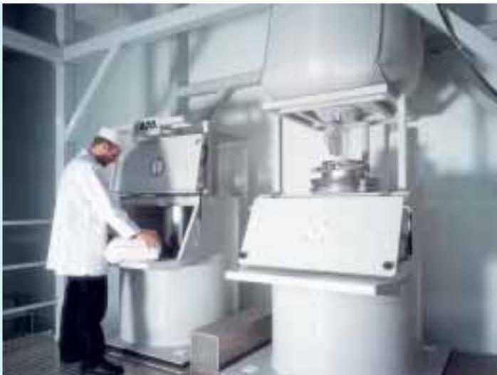
Einfülltrichter kombiniert mit Big-Bag Entleerung eingesetzt in einer Brotfabrik
