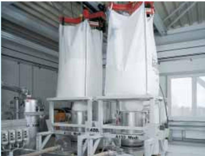
Big-Bags mit 2.000 Liter Fassungsvermögen und feststehendem Anschlusssystem, d. h. die Straffung zur Restentleerung wird durch das Hebezeug vorgenommen. Der Big-Bag wird kurz vor der Restentleerung nach oben gezogen, wodurch sich ein trichterförmiger Kegel bildet
