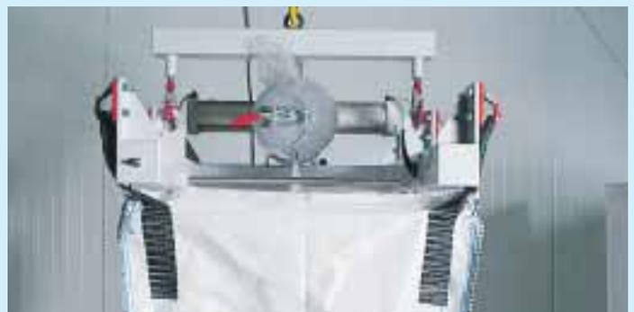
Big-Bag Hebezeug mit integrierter Inlet-Aufrolleinrichtung, die bei hochempfindlichen Produkten eingesetzt wird
