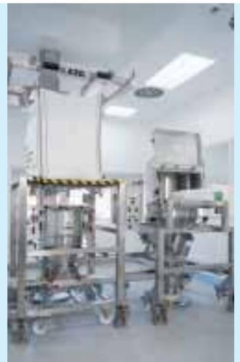
Lösung für den Pharmabereich: Big-Bag mit Staplertraverse – Auslaufstraffung mittels Hubsäule
