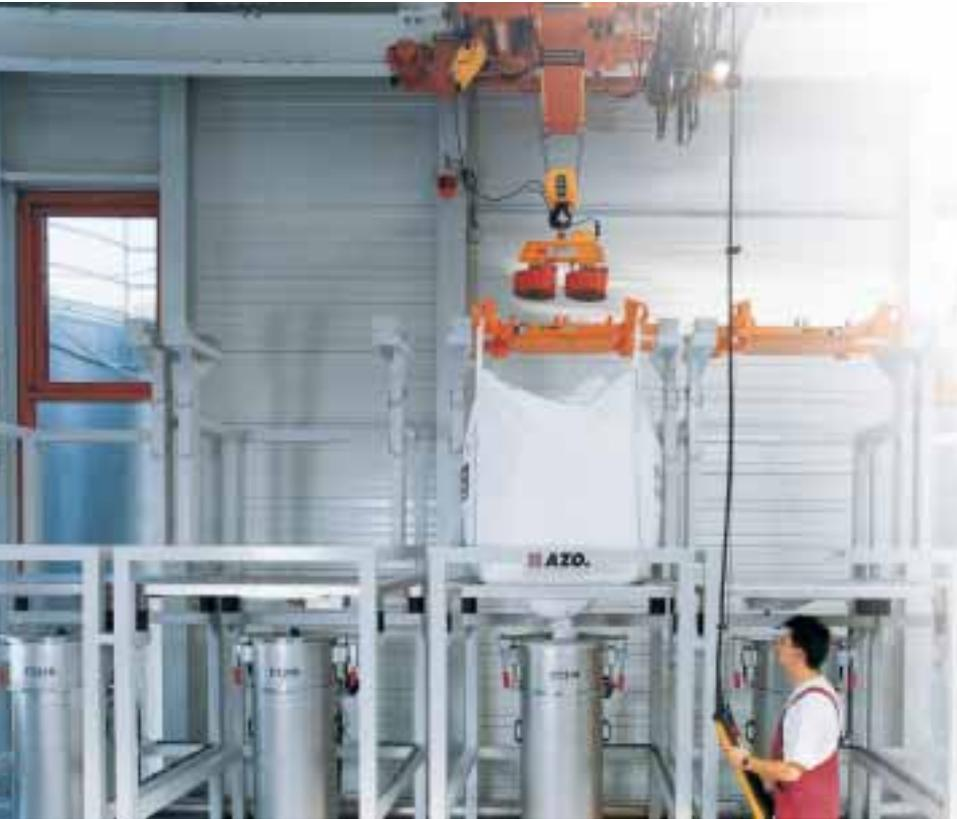
Bei diesen Big-Bag Entleerstationen setzt die Kranbahn, ausgestattet mit superstarken Magneten, den Big-Bag mit Magnettraverse auf die Entleerstation. Der Bediener kann den Kettenzug per Knopfdruck entkoppeln
