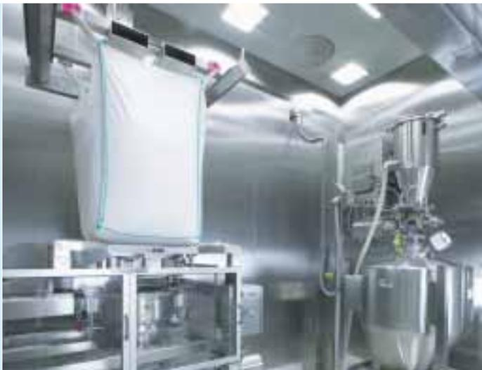
Big-Bag Entleerstation mit Staplertraverse zum Umfüllen von Big-Bags mit Kontrollsiebung und pneumatischer Überhebung in AZO BATCHAINER®
