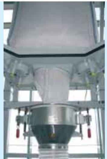
Big-Bag Entleerstation mit Walkeinrichtung. Als Alternative kann hier auch eine Vibrationsunterstützung eingesetzt werden
