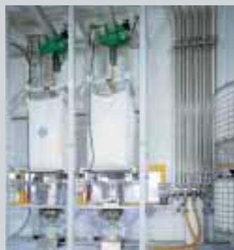
Big-Bag Entleerstationen mit integriertem Hebezeug zum Aufgeben von Big-Bags für Backmischungen. Nach dem Entleeren werden die Schüttgüter über Schleusen in pneumatische Fördersysteme aufgegeben. Über einen Kupplungsbahnhof können verschiedene Innensilos beschickt werden
