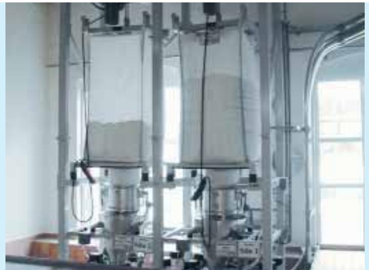
Big-Bag Entleerstationen in einer Brauerei zum Lagern von Kieselgur, das zur Bierfiltration benötigt wird. Diese Big-Bags dienen gleichzeitig auch als Lagervorrat. Durch das transparente Gewebe ist der Füllstand sehr gut zu erkennen
