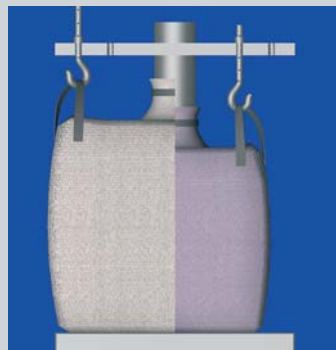
Mit den Aufhängeösen kann auf unterschiedliche Big-Bag Abmessungen reagiert werden
