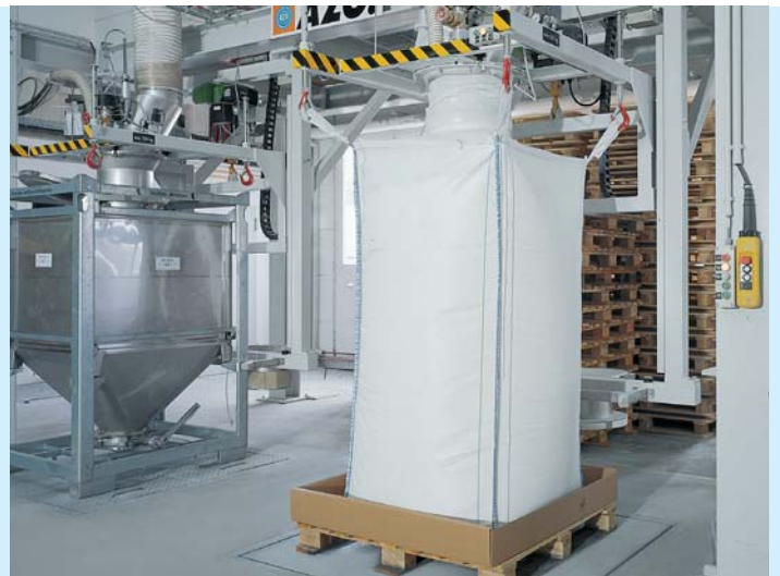
Abfüllen von PVC-Dryblend: Der Big-Bag mit Palette steht auf einer Bodenwaage, die Dosierung wird über Dosierschnecken vorgenommen
