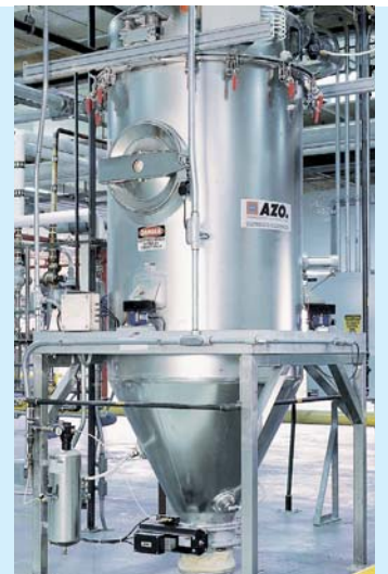
Durch die vorgeschaltete Waage können Wiegeprozess und Big-Bag Wechsel parallel und damit zeitsparend erfolgen
