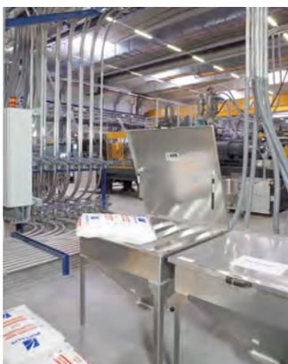
Einfacher Einfülltrichter für Granulat
