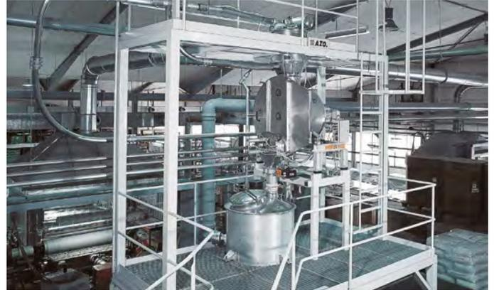
AZO®MIXOMAT-Waage über Verarbeitungsmaschine
