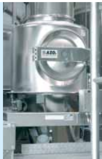
Förderwaage mit Doppel-Check-Einrichtung im Detail
