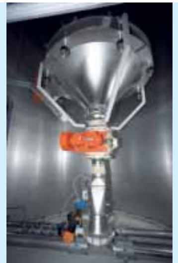
Staubfreie Produkteinschleusung und saubere Standzarge durch Saugförderung: links Vibrationsboden mit Dosierschnecke, rechts mit Dosierschleuse
