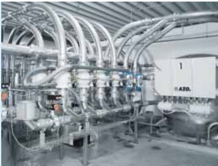
Förderwaage mit Ventilweiche
