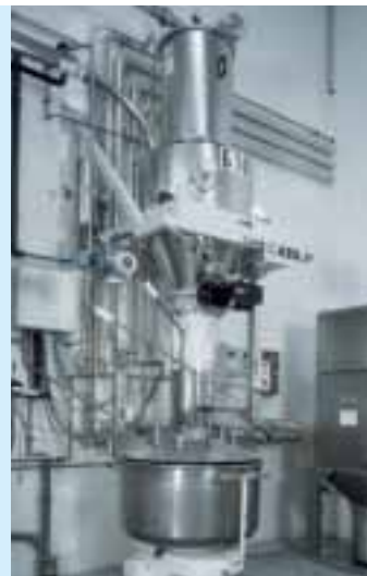
Knetbeschickung im Einrohrsystem
