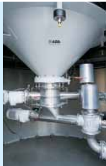
Staubfreie Produkteinschleusung und saubere Standzarge durch Saugförderung: links Vibrationsboden mit Dosierschnecke, rechts mit Dosierschleuse
