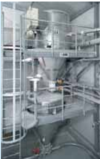
Zentralwiegestation mit Förderwaage und Auffangbehälter zur Wegförderung
