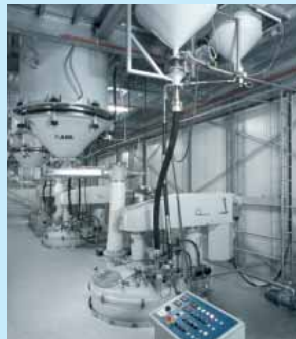
Dissolver-Beschickung bei der Fußbodenherstellung
