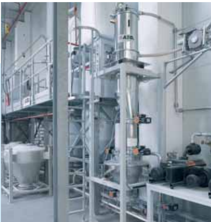
Förderwaage mit Einrohrsystem für Zuschlagstoffe bei der Produktion von Spachtelmassen
