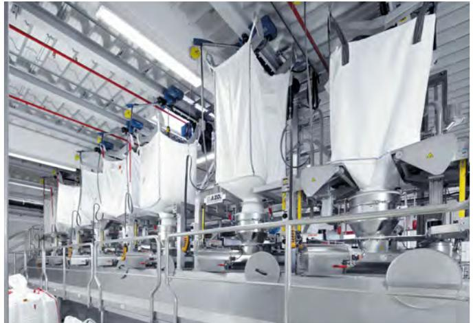
Big-Bag Entleerstationen mit Dosierschnecken für mittlere Komponenten
