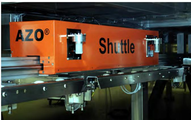
Mobile Shuttle-Einheiten für den schnellen Transport der Sammelcontainer
