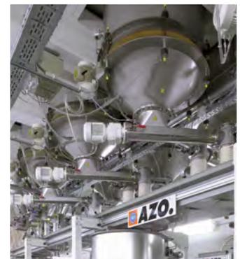
Exakte Dosierung mit AZO Dosierschnecken
