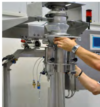
Einfaches Auswechseln der Befüllköpfe
