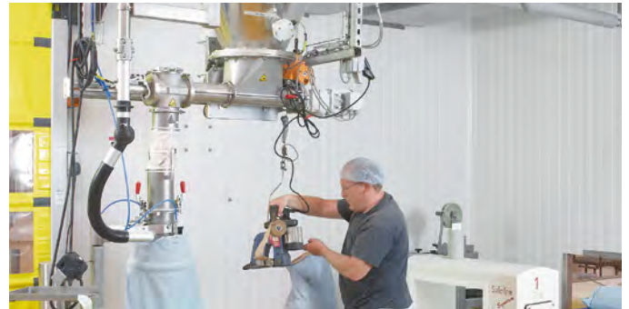
Dosierschnecke zur exakten Dosierung in Säcke
