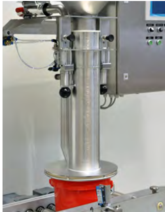
Befüllkopf mit elastischer Dichtfläche
