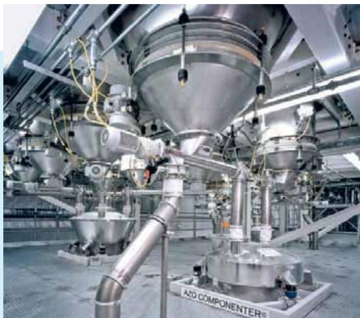
AZO COMPONENTER® à exécution circulaire pour la fabrication de profilés de fenêtres
