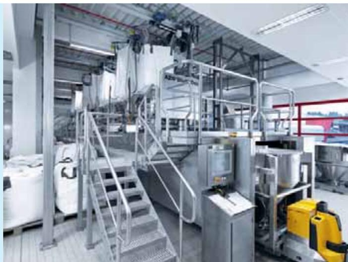
Éclusage d'un AZO MIXTAINER® dans la ligne de dosage
