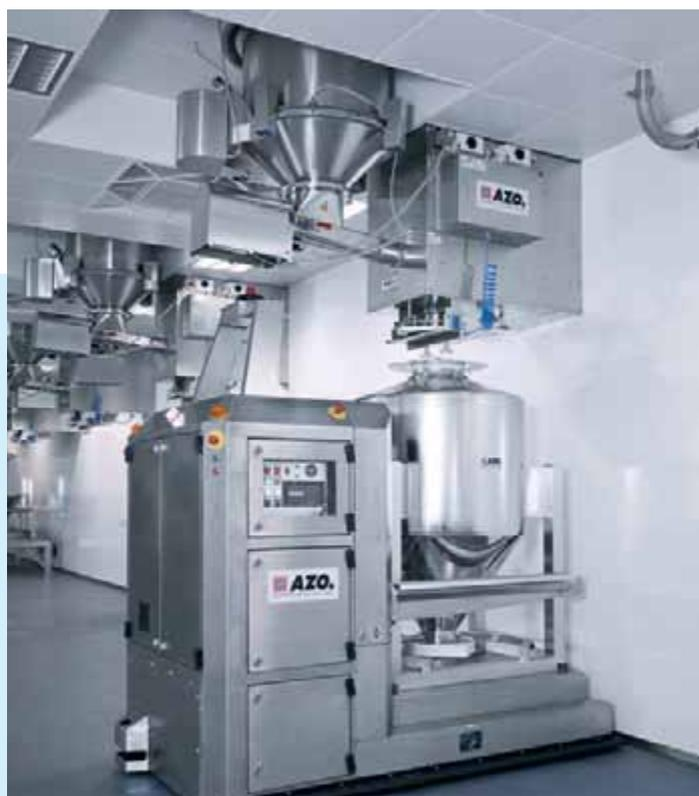
Véhicule de transport sans conducteur avec balance intégrée
