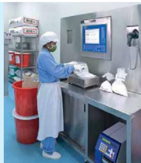
Poste de pesage ManDos avec lecture du code-barres et imprimante à étiquettes pour le pesage de principes actifs
