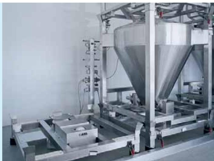
Stations d'alimentation pour AZO DOSITAINER® à entraînement intégré
