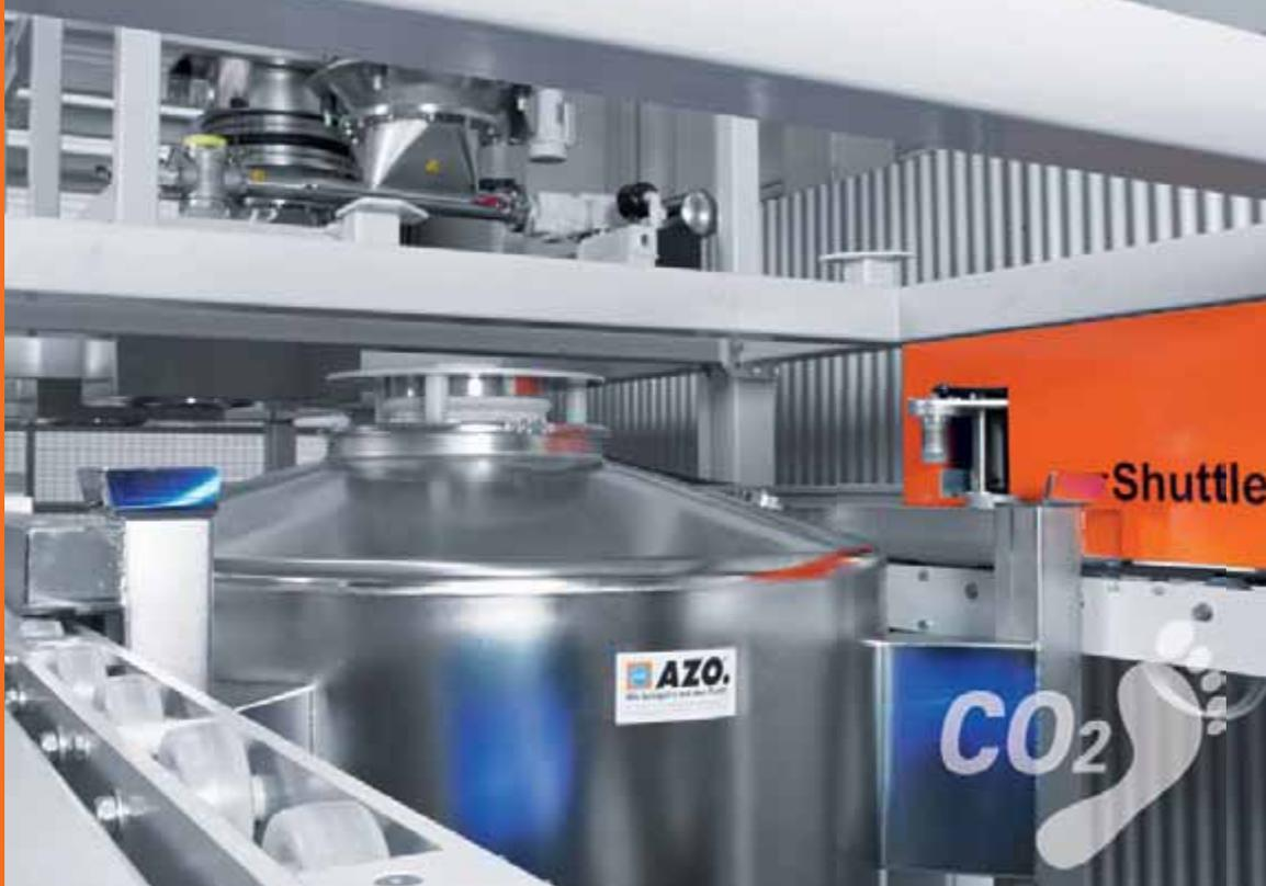
Pesage automatique dans AZO®ShuttleTainer
