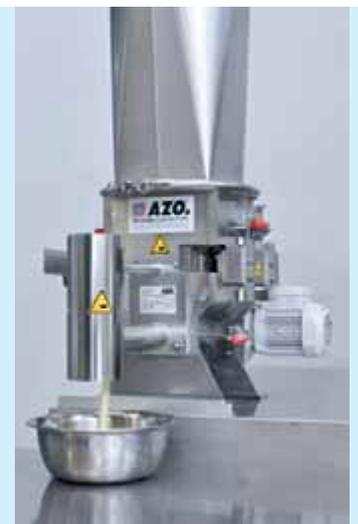
AZODOS® avec dispositif de microdosage
