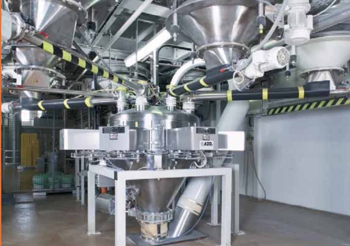
AZO COMPONENTER® à exécution circulaire dans une zone climatisée
