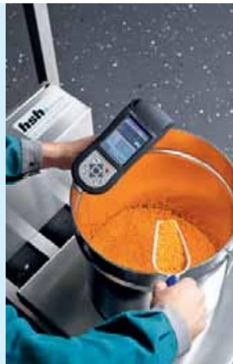
ManDos mobile : flexibilité maximale grâce à la balance itinérante et au terminal portable à connexion WiFi
