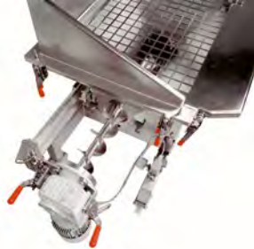
Zum Reinigen Dosierschnecke ausgezogen
