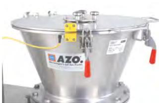
Deckel des Einlauftrichters mit Schnellverschlüssen und Sicherheitsschalter
