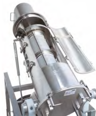
Große Inspektionsklappe zur Siebkontrolle.
