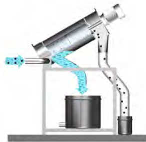
Stellung der Siebmachine Typ FLF 650 im Normalbetrieb.
