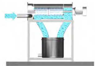
Stellung der Siebmachine Typ FLF 650 im Reinigungszustand.
