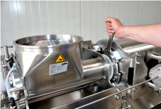
Verschiedene Verbindungsmöglichkeiten zwischen Dosier- und Siebmodul: Bayonettverschluss, Flanschverbindung, verschweißt
