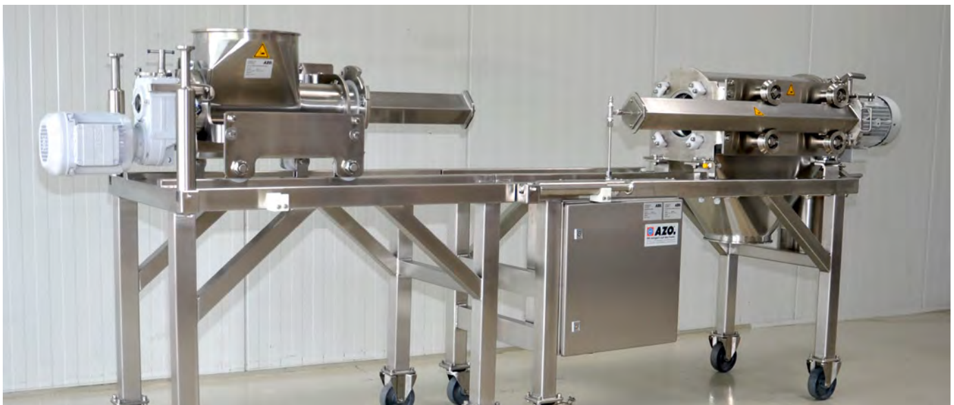
Adaptergestell für leichte Montage der auswechselbaren Dosiermodule
