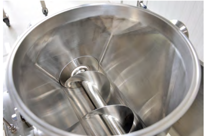
Totraumfreier Einlaufbereich minimiert Produktreste im Dosiermodul
