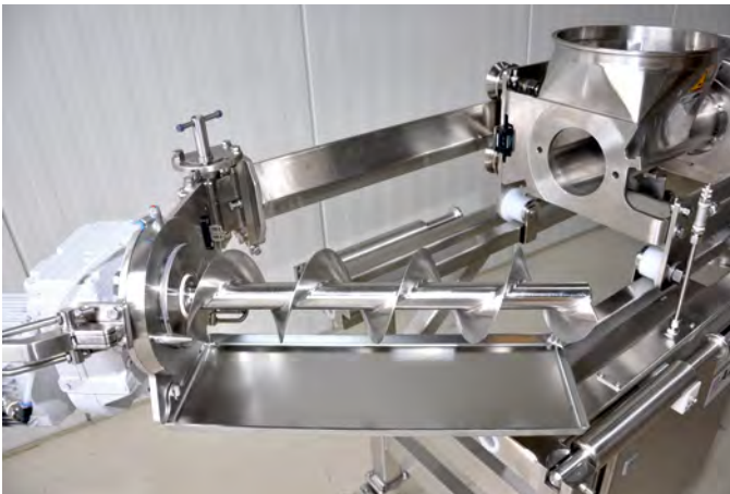
Rieselschutz beim Ausziehen des Dosiermoduls verhindert Verschmutzung
