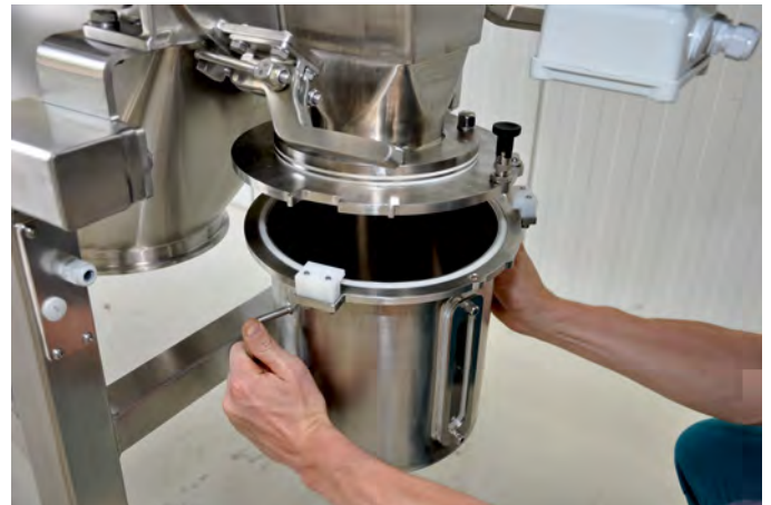
Grobgut-Auffangbehälter mit Bayonettverschluss zur leichten Demontage ohne Werkzeug
