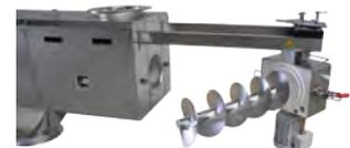
Dosierschnecke mit Antrieb ausgezogen und seitlich weggeschwenkt.
