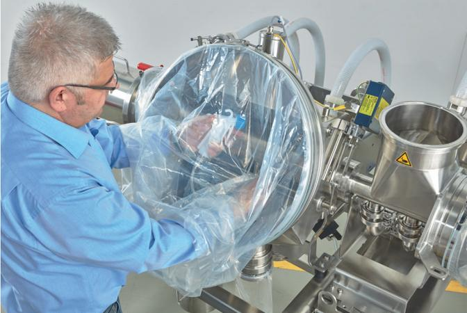
Durch die im Folienliner angebrachten Handschuhe kann die Inspektionsluke geöffnet und der Siebkorb durch Drehen kontrolliert werden.
