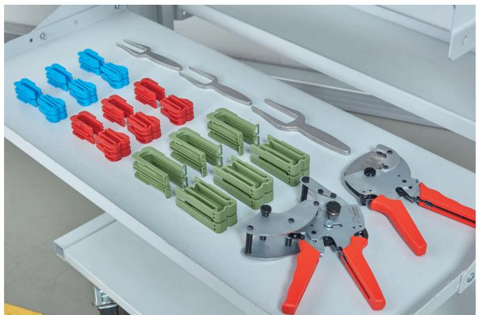
Werkzeugset mit verschiedene Größen von Crimpklammern, Verschlusszange, Schneidwerkzeug und Öffnungswerkzeuge.
