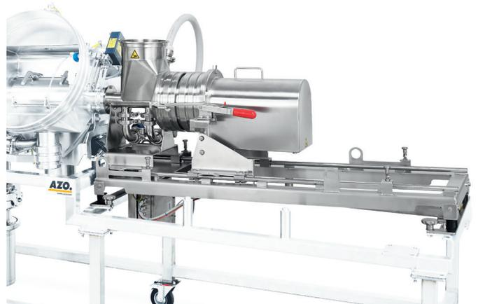
Zur Erreichung verschiedener Leistungsdaten kann das komplette Dosiermodul, bestehend aus Antrieb, Dosierschnecke, Produkteinlauf und Auszugsschlitten, getauscht werden. Dazu wird es auf einer Wechselschiene vom Rest der Siebmaschine getrennt.
