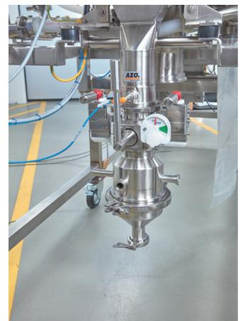
Zur Nassreinigung wird der Grobgutbehälter mit wenigen Handgriffen gegen ein Reinigungsmodul getauscht. Dieses ist mit einem Reinigungskopf und einem Anschluss für eine Drainageleitung ausgestattet.
