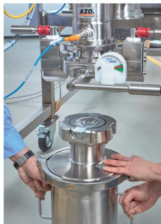
Der Grobgutbehälter ist über Splitvalve-Technik mit der Maschine verbunden. Das im Behälter gesammelte Grobgut kann so unter Containment-Bedingungen entsorgt oder dem Produktionsprozess wieder zugeführt werden.
