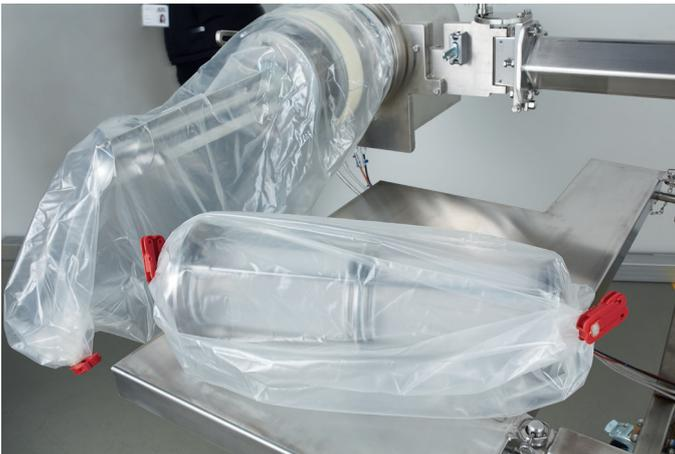
Mit Hilfe des Folienliners und der Crimp-Verschlüsse kann der kontaminierte Siebkorb unter Containment-Bedingungen gegen einen gereinigten Siebkorb getauscht werden. Während des gesamten Vorgangs bleiben Bediener und Umgebung vor Kontamination geschützt.
