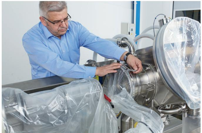
Nach dem Tauschen des Siebkorbs werden die kontaminierten Folienteile innerhalb des neuen Liners in die Seitentaschen gezogen. Nach dem Abcrimpen der Taschen können diese samt Inhalt entsorgt werden.
