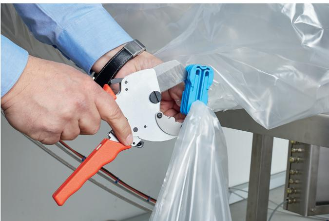
Zum Verschließen des Folienliners an einer bestimmten Stelle, wird die Crimpklammer manuell über den Beutel gezogen und mit einer speziellen Verschlusszange zusammengepresst. Danach kann der Crimp mittels Schneidwerkzeug aufgetrennt werden.
