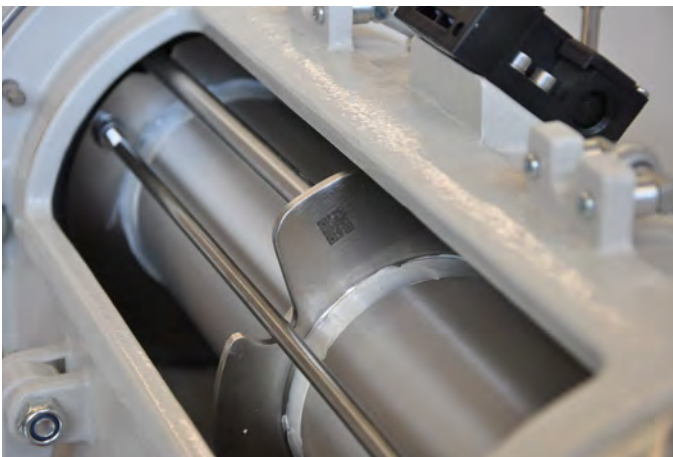
Eindeutige Kennzeichnung des Siebkorbs. Identifikation über QR-Code.
