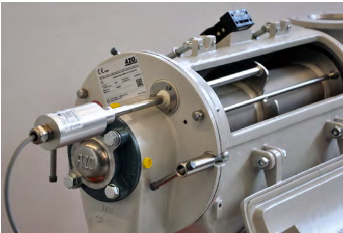
Siebkorb mit Ultraschallkonverter. Die Einbringung der Schwingungen auf das Siebgewebe erfolgt über den Mittelring. Das Edelstahlgewebe ist auf die Siebringte aufgeklebt.
