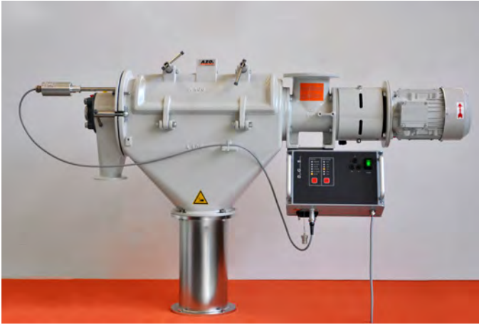
Wirbelstrom-Siebmaschine E360 aus Aluminiumguss, lackiert. Ultraschallunterstützung nachgerüstet.
