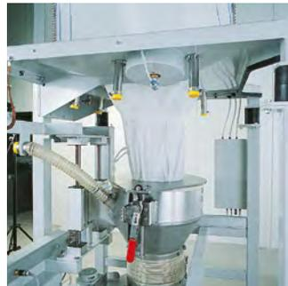
Durch Absenken des Anschluss-systemes wird der Big-Bag Aus-lauf gespannt. Big-Bag zur Entleerung bereit.
