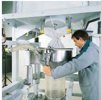
Big-Bag Auslauf bereits über Einlaufstutzen gestülpt und mit Anpressscheibe festgeklemmt. Öffnen der Verschlusschnur am Big-Bag Auslauf.
