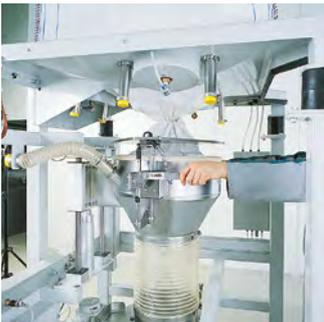
Nach oben gefahrenes Anschluss-system mit geöffneter Anpress-scheibe.
