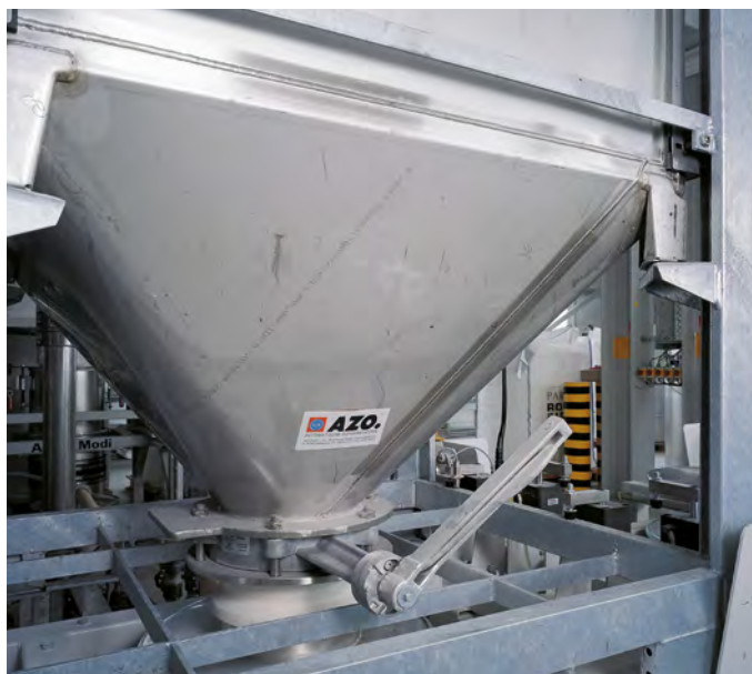
Die patentierte Andockmanschette verbindet den Klappenauslauf des Containers mit dem nachfolgenden Einlaufstutzen staubdicht.
