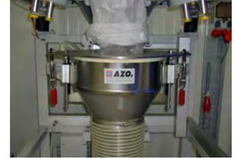
Die Straffung des Big-Bag Auslaufes wird durch pneumatische Absenkung des Anschlussystems erreicht.
