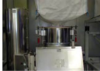
Nach dem Anschließen wird der Big-Bag durch das Hebezeug leicht angehoben. Dadurch wird eine Straffung des Big-Bag Auslaufes erreicht.
