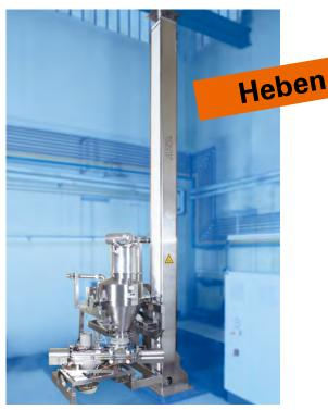
Die Gebinde oder verfahrenstechnische Module werden ebenerdig von der SchubLift-Säule übernommen und entsprechend auf die Arbeitsposition angehoben.
