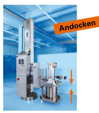
Mit der SchubLift-Säule ist es möglich sehr präzise und passgenau an entsprechende Gebinde freiprogrammiert oder manuell gesteuert anzudocken.
