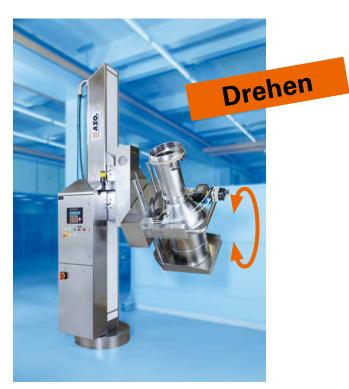
Mit der neuen SchubLift-Säule ist es möglich die Gebinde zu drehen und an Behälter oder Geräte anzudocken um die Gebinde zu entleeren.
