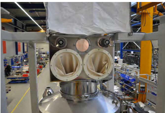
Big-Bag Vakuum-Andocksystem mit Handschuhen
