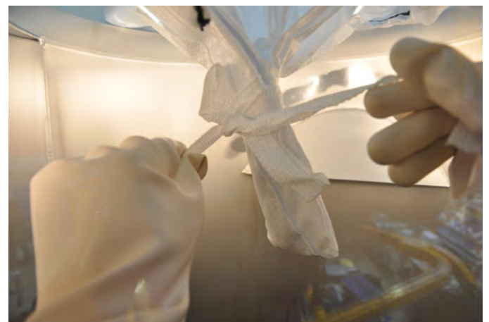
Öffnen des Big-Bag Auslaufes über die Handschuhe
