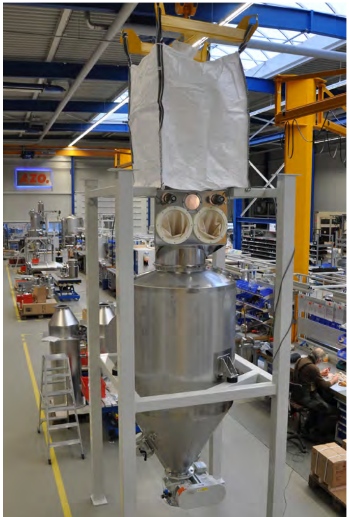
Beispiel einer kompletten Big-Bag Entleerstation
