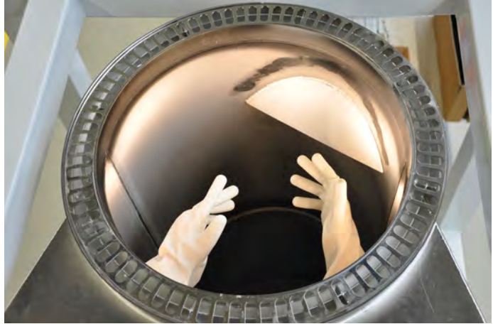
Kreisförmige Vakuum-Besaugung zum staubdichten Andocken und Fixieren des Big-Bags Variante: mit Handschuhen
