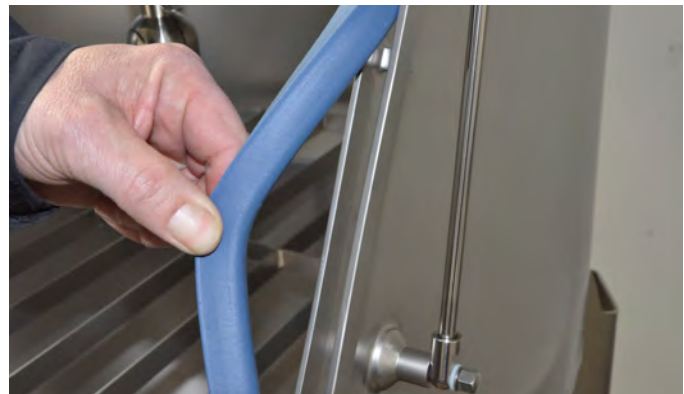
Dichtung leicht zu montieren und zu demontieren, da nicht geklebt
