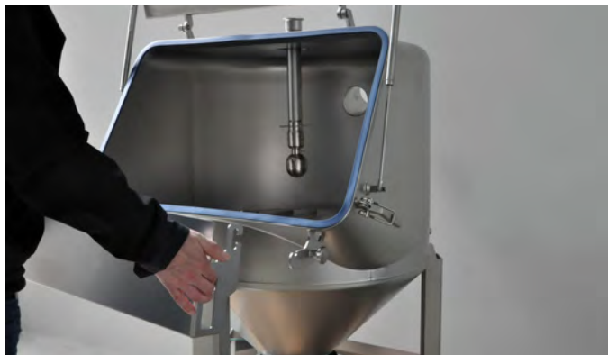
Sackauflage kann nach unten geklappt oder abgenommen werden
