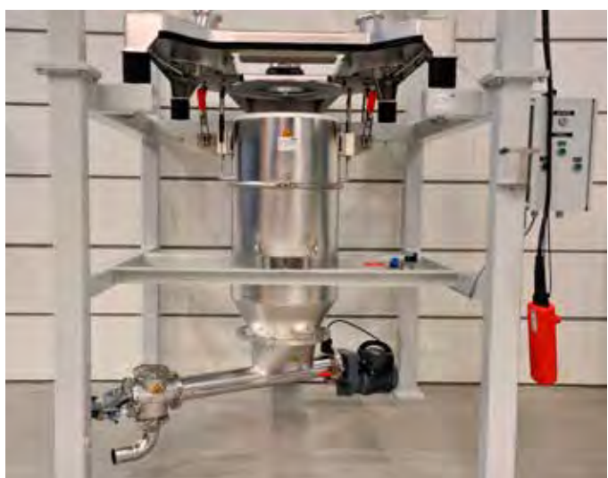
Big-Bag Anschlussystem mit Behälter Ø 500 und angebauter Dosierschnecke (kein Modul des Baukastens)
