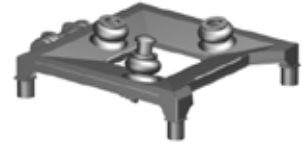
Auflageplattform mit Walkeinrichtung für besonders schwerfließende Schüttgüter, opt. mit Vibrati- onsunterstützung
