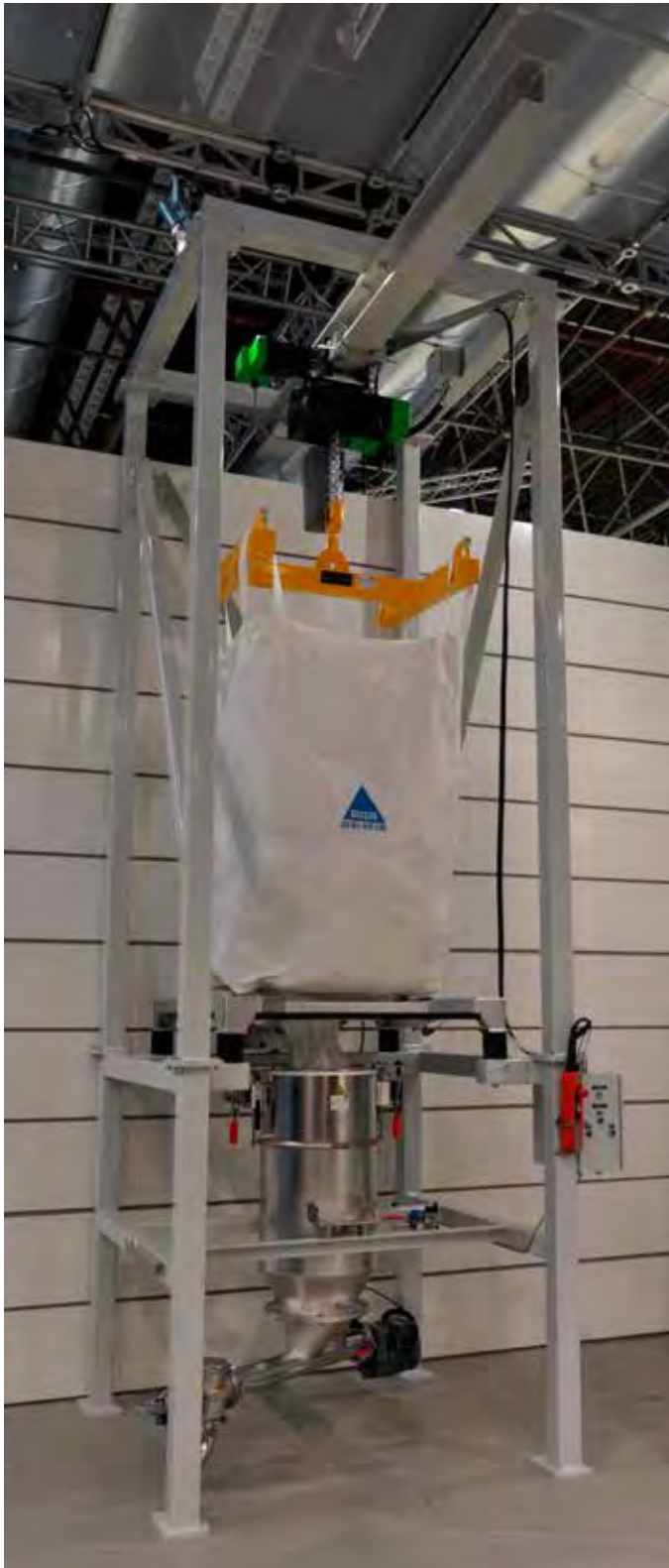
Modulare Big-Bag Entleerstation mit angebauter Dosierschnecke (kein Modul des Baukastens)
