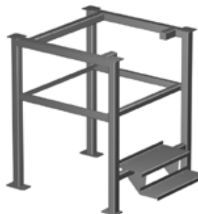
Untergestell mit zwei Stufen Höhe: 1980 mm
