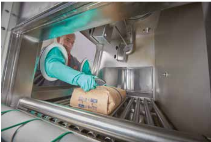
Glovebox mit Zweihand-Sicherheitsbedienung und integriertem Messer zum Öffnen der Säcke
