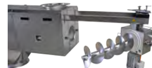
Vis de dosage avec entraînement extrait et pivoté sur le côté.
