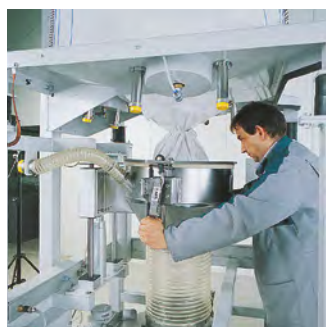
Bridage de la poche, raccordement au système de dépoussiérage
