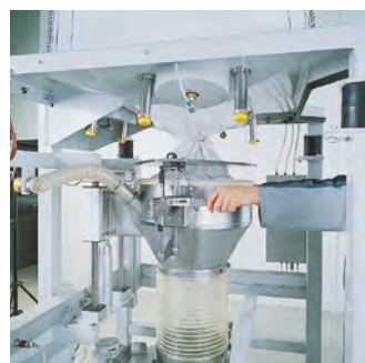
Mise en place du Big bag en isolant la poche interne.
