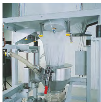
Descente du système de vidange pour tension de la poche
