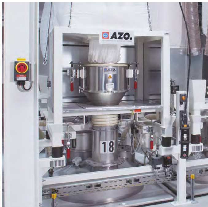
La tension de l'orifice de sortie du Big Bag est possible en abaissant le système de raccordement.
