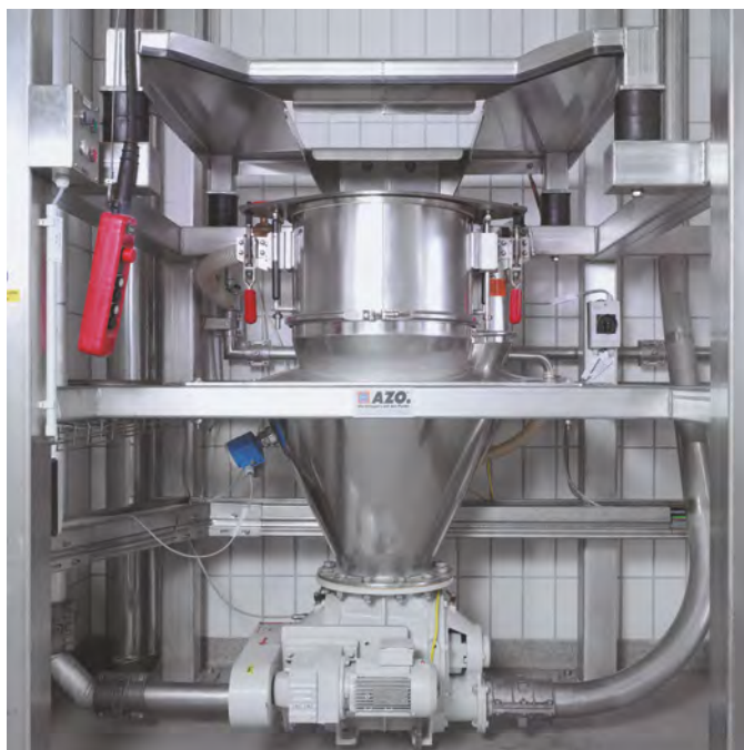
Après le raccordement, le Big Bag est légèrement soulevé par l'engin de levage. Cela permet la tension de l'orifice de sortie du Big Bag.
